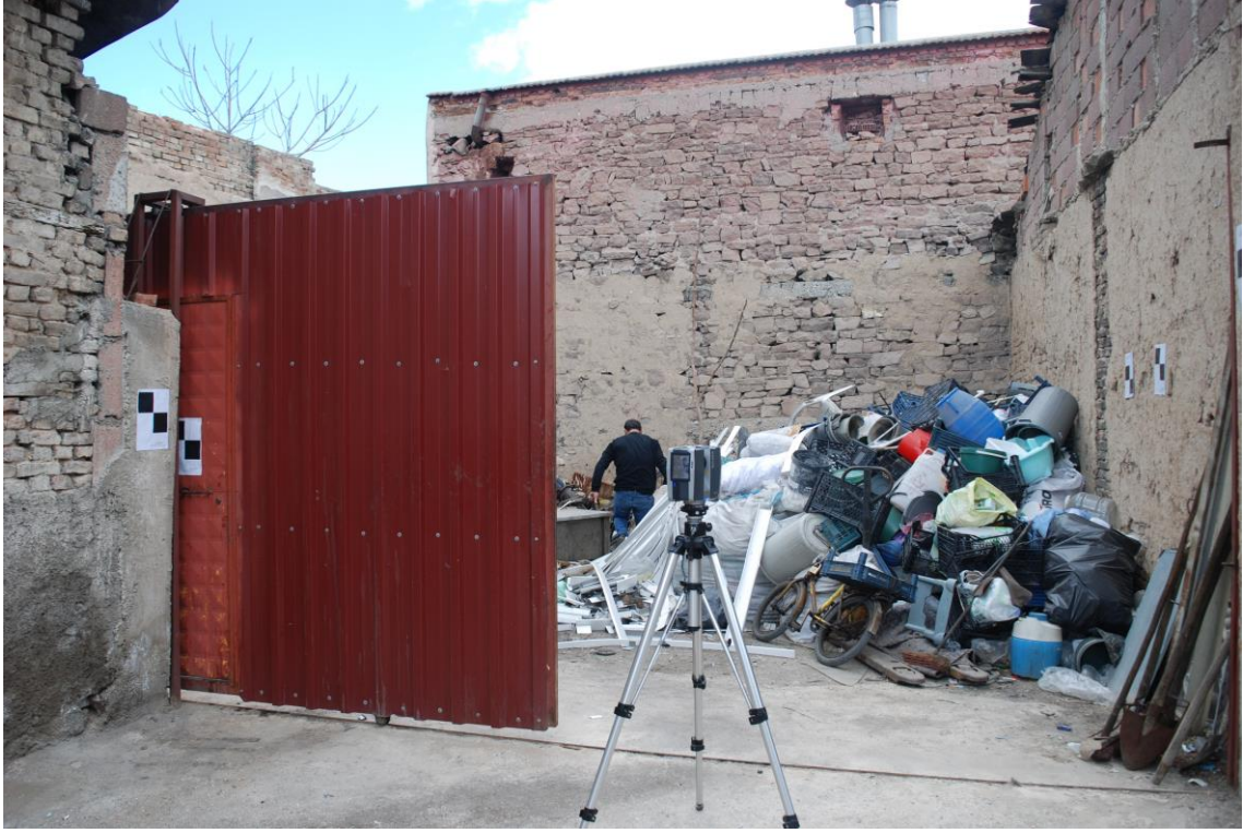
Şekil 5.18. Lazer Tarayıcının Kurulumu
