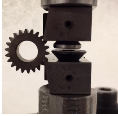
Şekil 2.10. Tek diş eğilmeli yorulma test düzeneği (Olsson ve ark., 2016)
