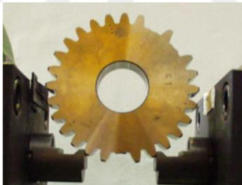
Şekil 2.4. Tek diş eğilmeli yorulma test düzeneği (Conrado ve ark., 2017)
