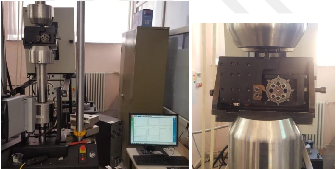
Şekil 3.28. Instron 8801 yorulma test cihazının görünümü
