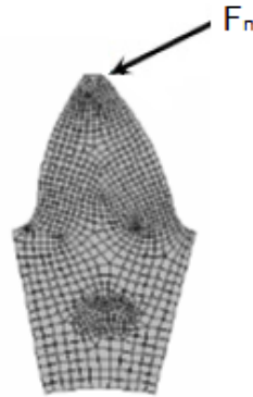
Şekil 2.18. Sonlu elemanlar metodu ile dişli çark dişinde diş dibi eğilme gerilmesinin belirlenmesi için kullanılan model (Karpat ve ark., 2006)
