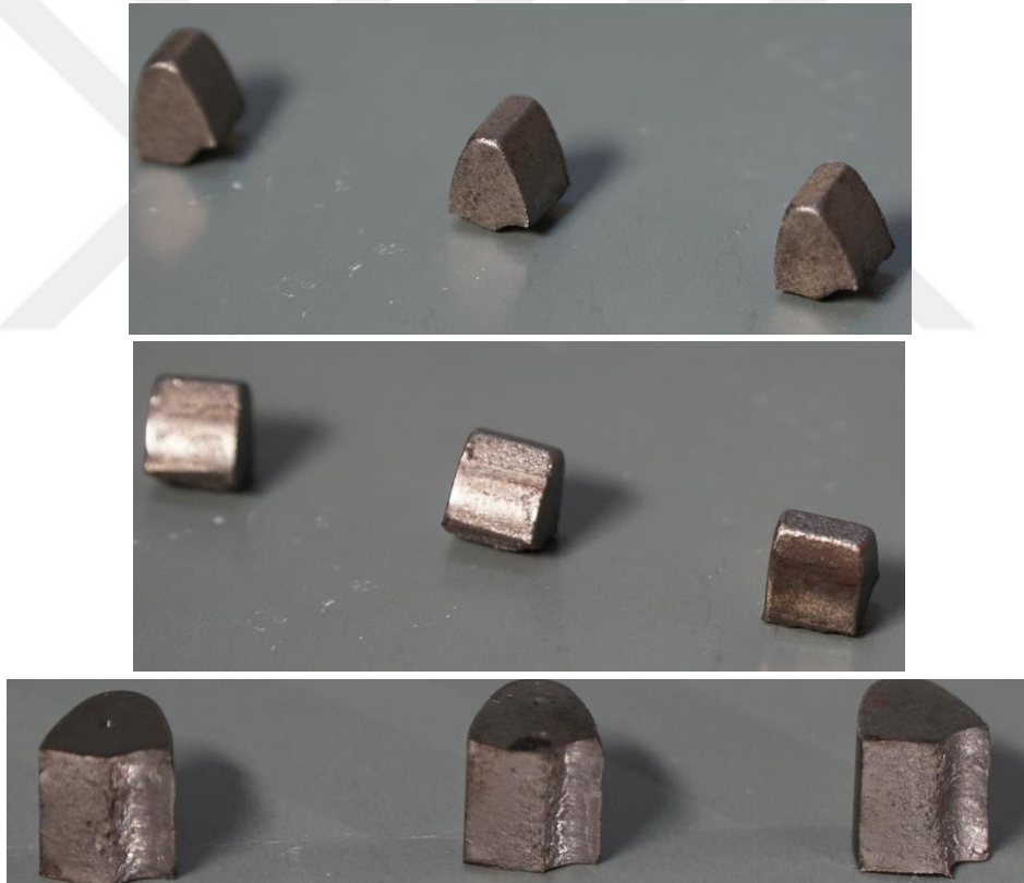
Şekil Ek2.4. 20^{\circ}/22^{\circ} kavrama açısına sahip simetrik düz dişli çark test numunelerinin deney sonrası kırılan diş görünümleri
