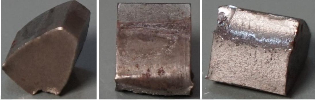
Şekil 4.26. 20°/25° kavrama açısına sahip test dişlisinin yorulma sonucunda diş dibinden kırılmış hali
