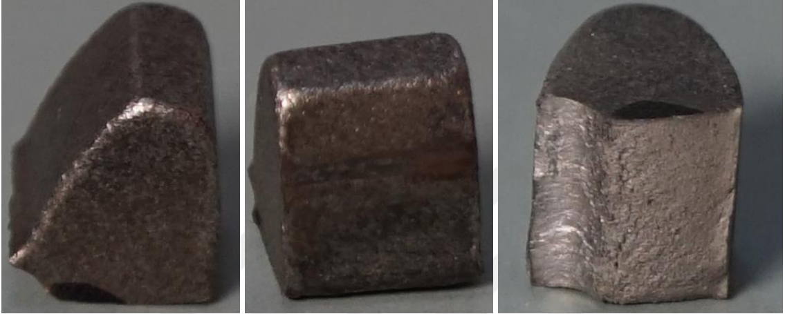
Şekil 4.8. 20°/20° kavrama açısına sahip test dişlisinin yorulma sonucunda kırılmış hali
