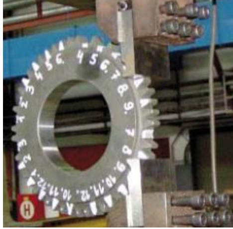
Şekil 2.5. Tek diş eğilmeli yorulma test düzeneği (Maršálek ve Moravec, 2011a)
