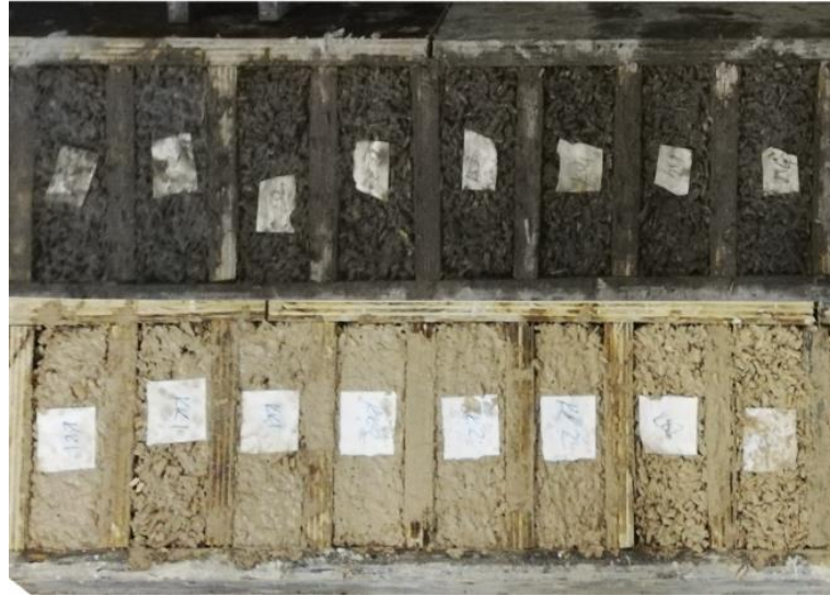
Şekil 4.4. Plywood kalıplarda hazırlanan numuneler
