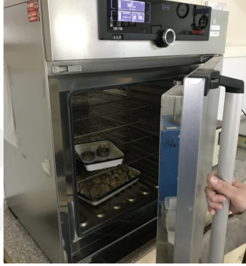
Şekil 5.30. D50 çap/elek analizi deneyinde kullanılan numunelerin etüve alınması
