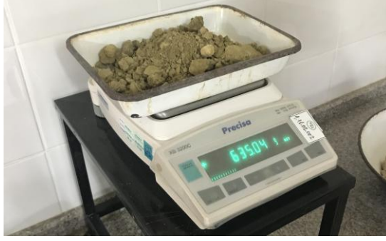
Şekil 5.29. D50 çap/elek analizi deneyinde numune ağırlığının ölçümü örneği
