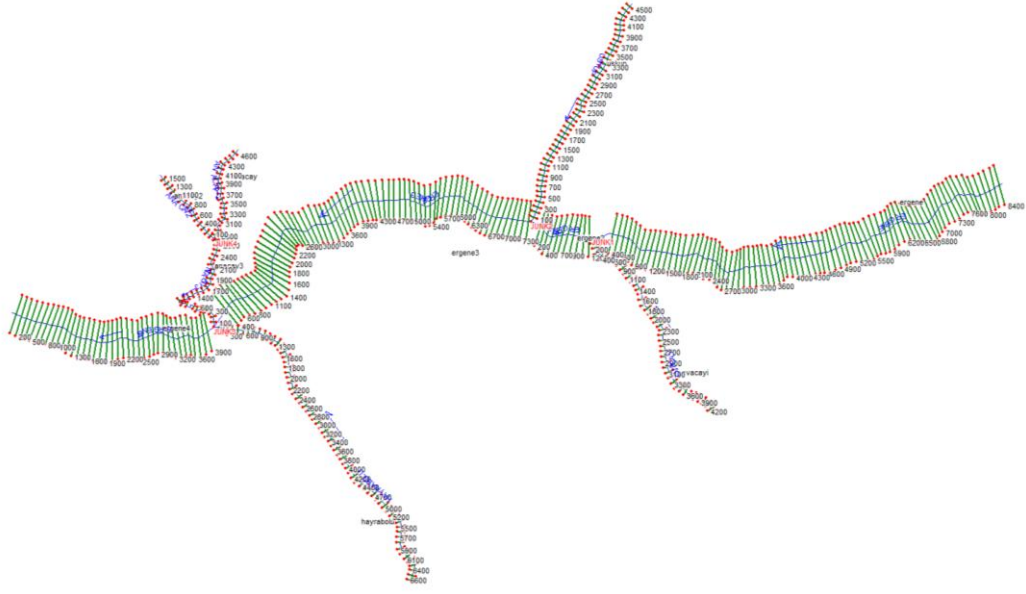
Şekil 5.47. HEC-RAS'ta 1-boyutlu model örneği (en kesitli): Alpullu haritası
