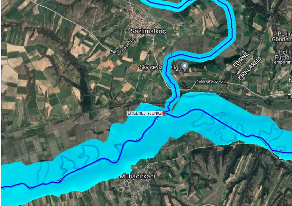
Şekil 6.77. Muhacirkadı, Sazlımalkoç yerleşkeleri ve Q500 taşkın akımı
