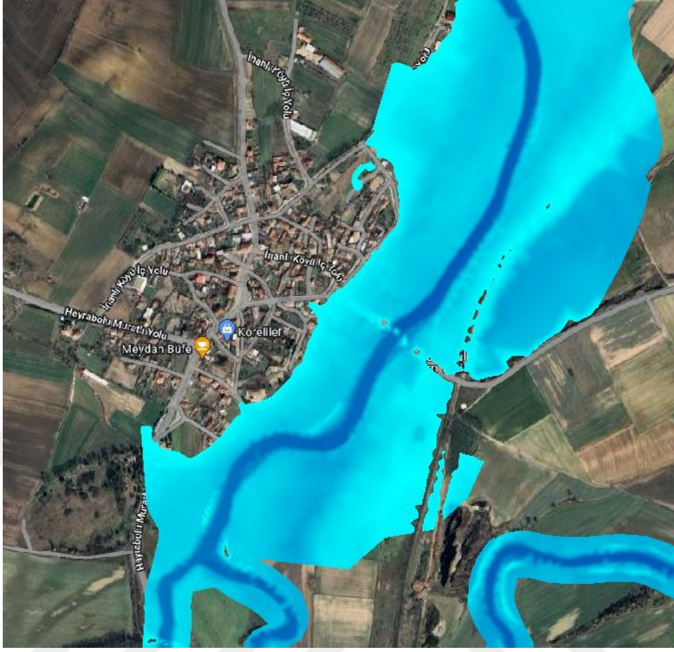
Şekil 6.6. İnanlı Yerleşkesi ve Q500 taşkın akımı
