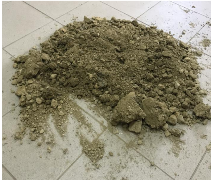
Şekil 5.28. D50 çap/elek analizinde numunenin çeyrekleme yöntemi ile birleştirilmesi sonrası laboratuvar hali örneği: Alpullu haritası
