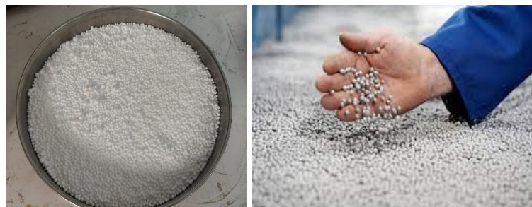
Şekil 2.2 Pentan gazı ile ısıtılarak şişirilmiş polistiren boncukları
