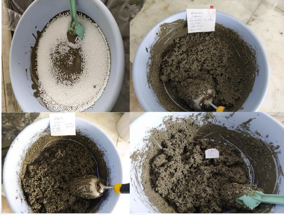
Şekil 3.11 Karışıma EPS boncukları eklenmiş görünümü
