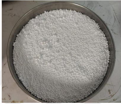
Şekil 3.1 Hafif dolguda kullanılan genleştirilmiş polistiren (EPS) daneleri
