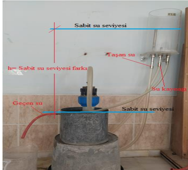
Şekil 3.18 Sabit seviyeli permeabilite deneyinin yapılışı
