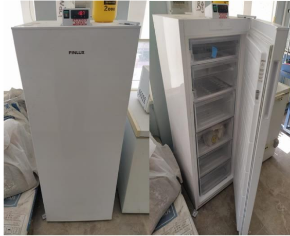
Şekil 3.17 Donma çözülme deneyinde kullanılan derin dondurucu
