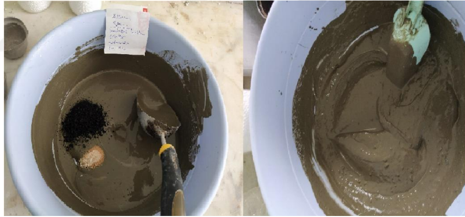
Şekil 3.10 Çimento, kum, atık lastik ve su karışımı
