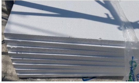
Şekil 2.3 Levha şeklindeki polistiren köpüğü
