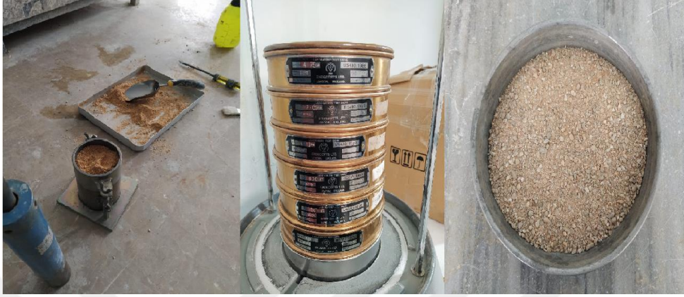
Şekil 3.6 Kum numunesine ait proktor deneyi ve elek analizi görünümü
