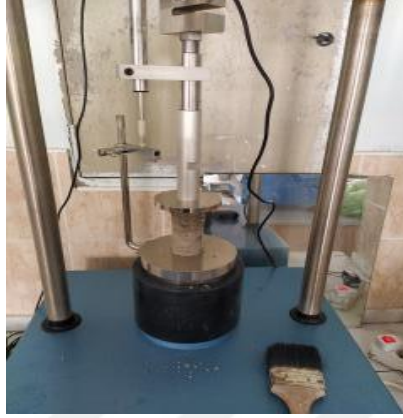
Şekil 3.13 Serbest basınç deney aleti ve numunenin yerleştirilmiş görünümü
