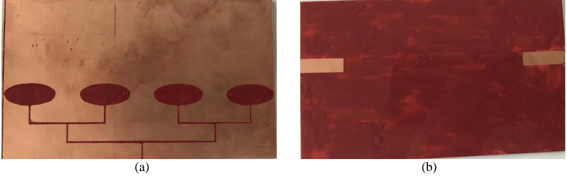
Şekil 4.34 EMŞA' nın toprak ve yama kısımlarının ojenmesi a) Ön yüzü, b) Arka yüzü
