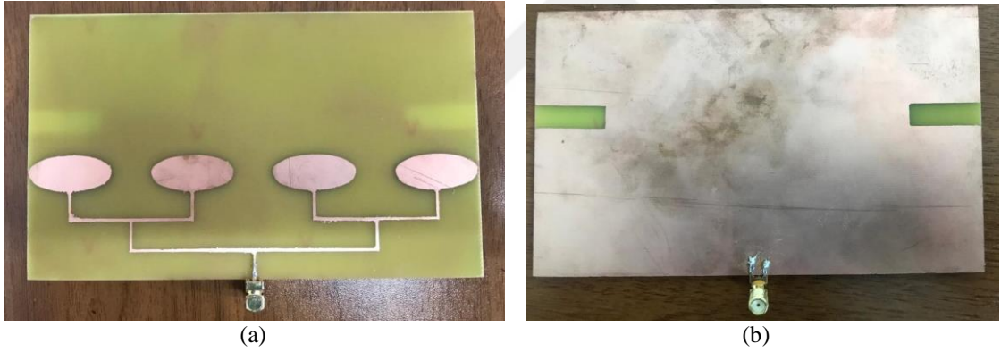
Şekil 4.35 Yapışkan PVC folyo ile maskelenerek üretilen EMŞA' nın görünümü a) Ön yüzü, b) Arka yüzü
