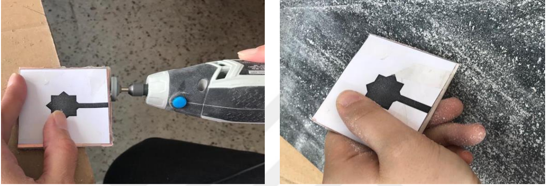
Şekil 4.43 SYMŞA' nın tabanının istenilen boyutlara getirilmesi
