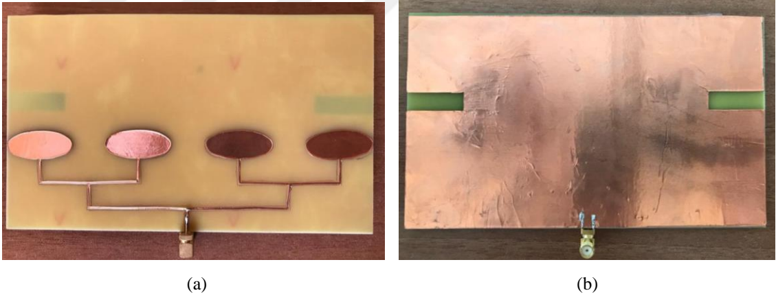
Şekil 4.42 Bakır bant ile üretilen EMŞA' nın görünümü a) Ön yüzü, b) Arka yüzü
