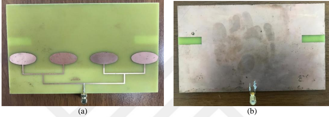
Şekil 4.31 Ütü ile baskı devre yöntemi kullanılarak üretilen EMŞA' nın görünümü, a) Ön yüzü, b) Arka yüzü
