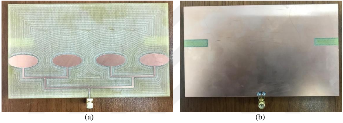
Şekil 4.40 PCB cihazı ile üretilen 90° SMA konektör kullanılan EMŞA' nın görünümü a) Ön yüzü, b) Arka yüzü
