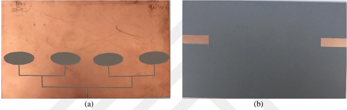
Şekil 4.36 EMŞA' nın yapışkan PVC folyo ile kaplanması, a) Ön yüzü, b) Arka yüzü
