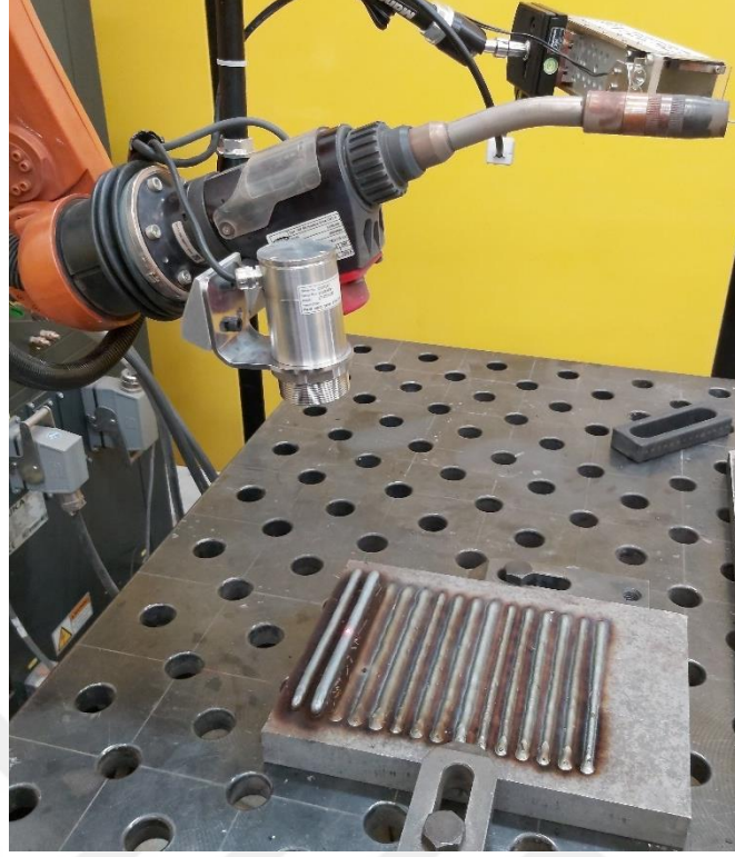
Şekil 10. Pirometre Katmanlar Arası Sıcaklık Ölçümü
