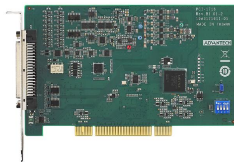
Şekil 4.23. Veri toplama kartı
