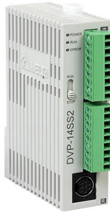
Şekil 4.22. Programlanabilir Mantıksal Denetleyici
