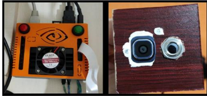
Şekil 3.43. Nvidia Jetson Nano ve dual-sensör (RGB+IR) yapısı
