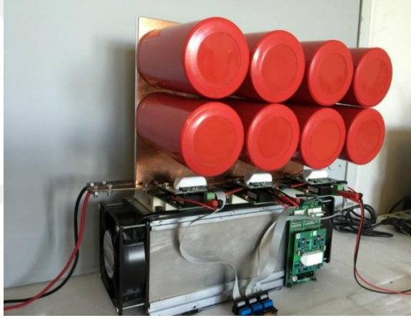
Şekil 4.62. 75kW’lık fan destekli doğal-hava soğutmalı güç elektroniği devresinin bara bağlantısı
