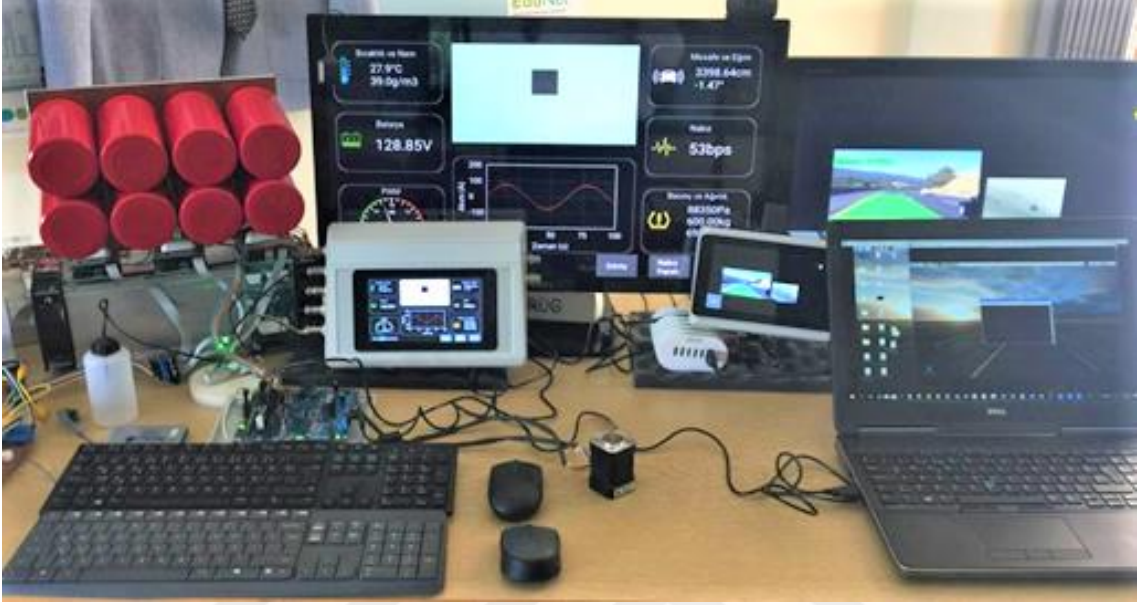
Şekil 4.126. Adaptif yapı üst kontrolörü ile FDAM kontrol ve güç sisteminin birbirine bağlı çalışan tüm sistem deney düzeneği
