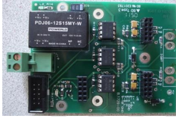
Şekil 4.41. IGBT sürücü devresi gerçekleştirilmiş hali
