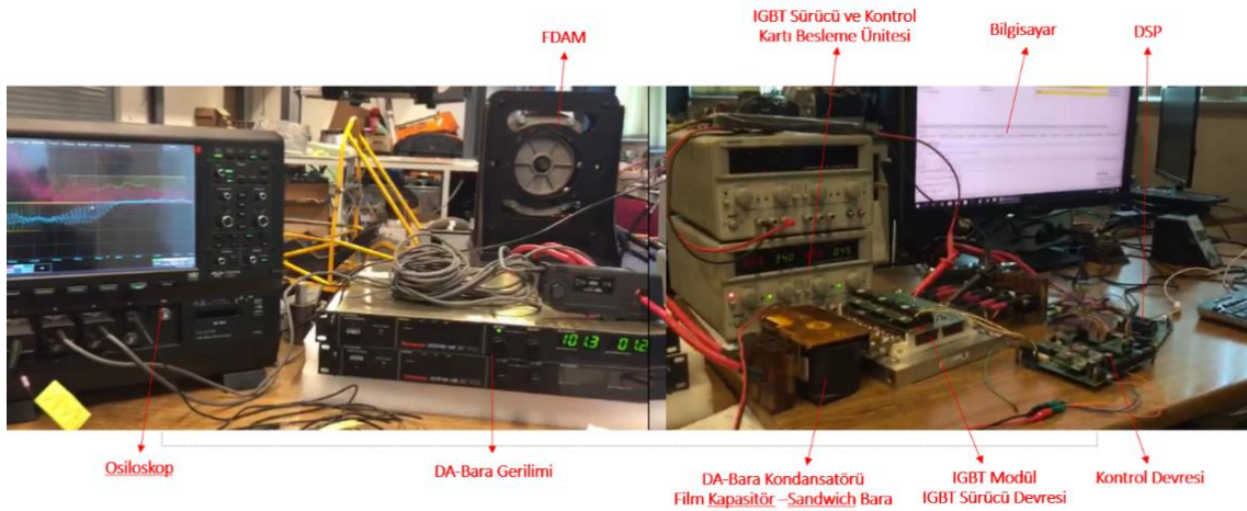
Şekil 4.136. 75 kW sıvı soğutmalı tam kontrollü üç faz DA-AA dönüştürücü ve kontrol sistemi deney düzeneği
