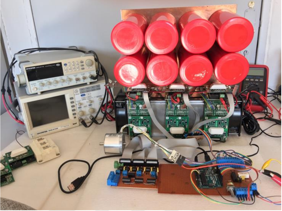
Şekil 4.114. 75 kW hava soğutmalı tam kontrollü üç faz DA-AA dönüştürücü (Inverter- Traction)
