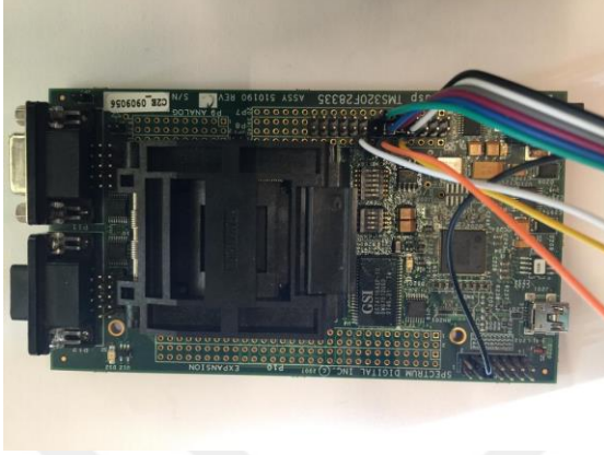
Şekil 4.112. TMS320F28335 geliştirme kontrol kartı.
