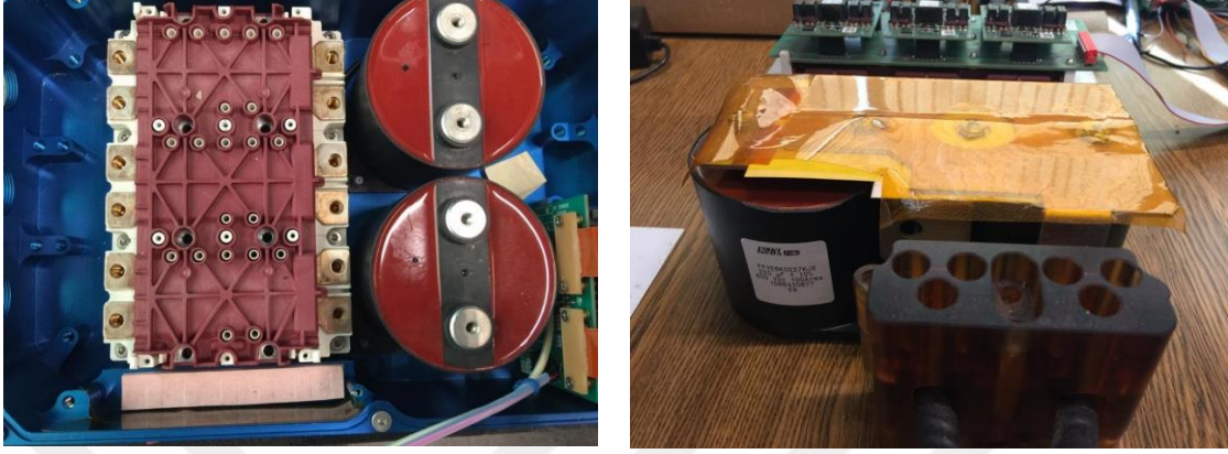
Şekil 4.84. SKiM459GD12E4 IGBT modül ve film kapasitör bağlantısı
