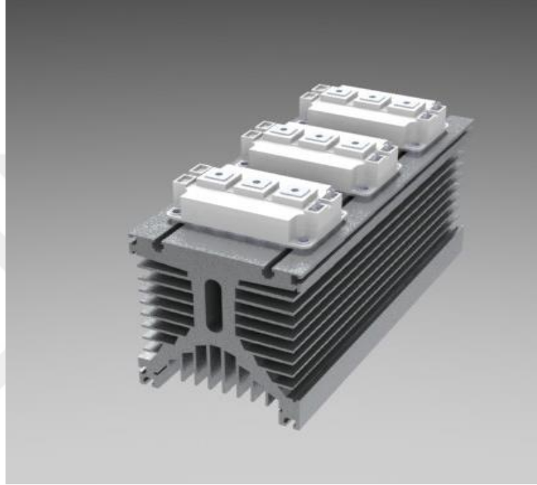
Şekil 4.56. IGBT modüllerin soğutucuya yerleşimi
