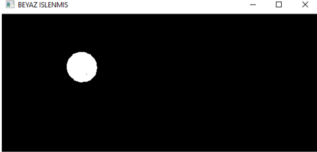
Şekil 4.8. Alınan görüntünün arka plan ve diğer öğelerden ayrılmış hali
