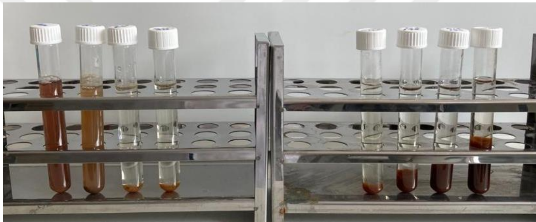
Şekil 4.23. Çelik-çelik elektrot ile mezbaha atıksuyunun elektrokimyasal oksidasyonunda elektrotlara 15 V akım uygulanması halinde alınan numunelerin zamanla değişimi
