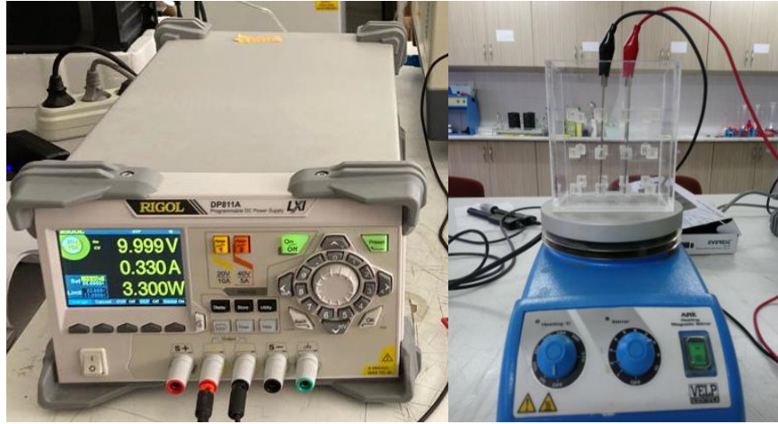
Şekil 3.1. DC güç kaynağı ve elektrokimyasal oksidasyon reaktör düzeneği
