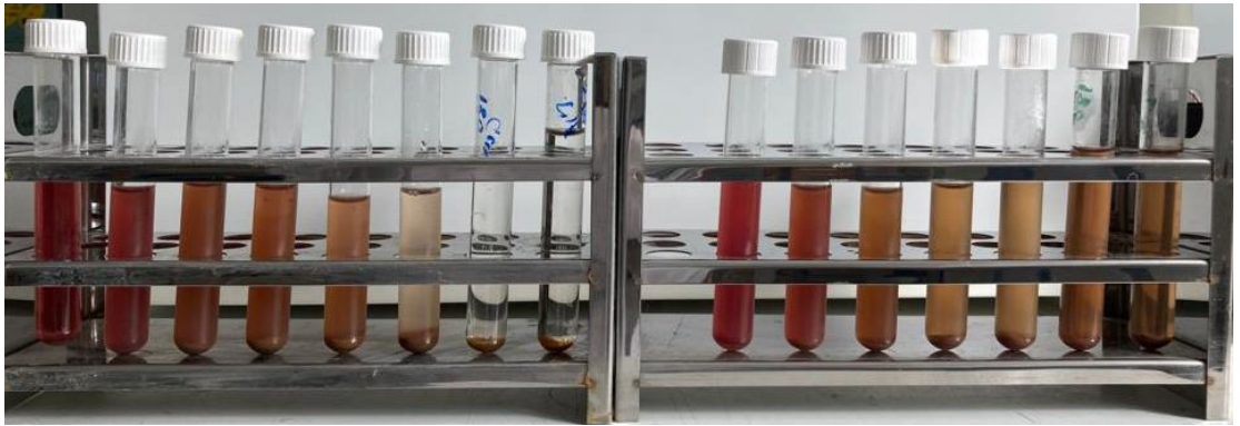
Şekil 4.5. Çelik-çelik ve grafit-grafit elektrot ile mezbaha atıksuyunun elektrokimyasal oksidasyonunda reaksiyon süresinin etkisi
