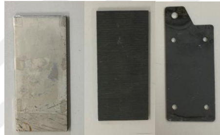
Şekil 3.2. Denemeler süresince kullanılan (çelik, grafit, BDD) anot ve katotlar
