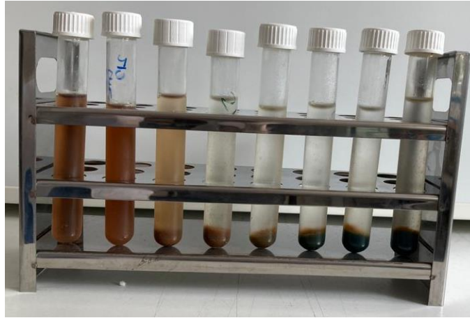
Şekil 4.13. Ön arıtım yapılmış mezbaha atıksuyunun çelik-çelik elektrotlar ile elektrokimyasal oksidasyonunda reaksiyon süresinin etkisi
