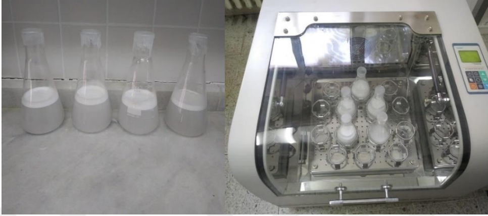
Şekil 3.2. Cam boncukların HF asit ile karıştırılması
