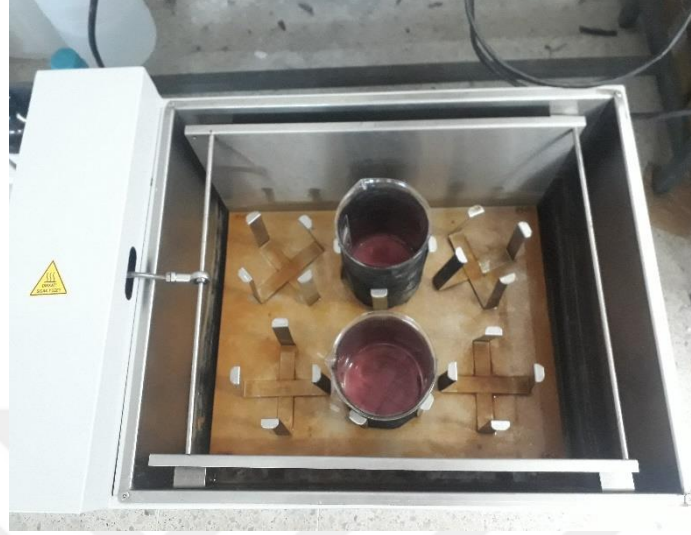
Şekil 3.11. Beherlerin beher tutuculara yerleştirilmesi
