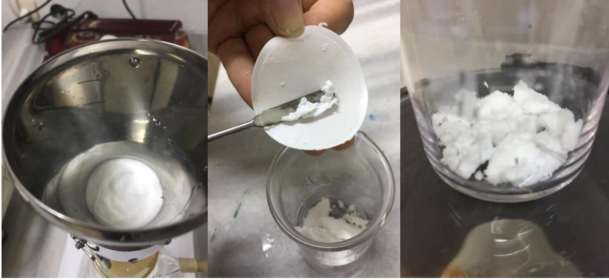
Şekil 3.6. Cam boncuk üzerine sabitlenmiş Nd katkılı TiO_2
