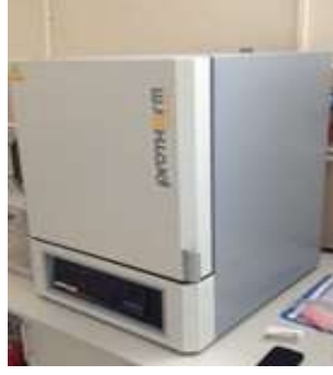
Şekil 7.9. Selçuk Üniversitesi Teknoloji Fakültesi Isıl İşlem Laboratuvarında, T6 ısıtımının yapıldığı dijital kontrol programlı Protherm marka ısıtma fırını
