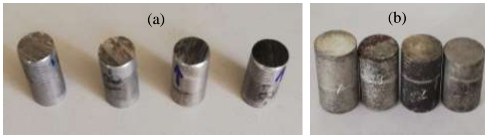
Şekil 7.25 Daldırmalı korozyon deneyinde kullanılan numuneler (a) Korozyondan önceki numuneler (b) 25 0 C sıcaklıkta 590 saat korozyona maruz kalan numuneler
