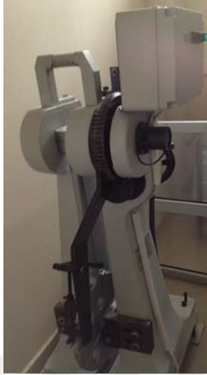
Şekil 7.20 KTÜN Metalürji ve Malzeme Mühendisliği Bölümü Metalografi Laboratuvarında V-Charpy çentik darbe test cihazı
