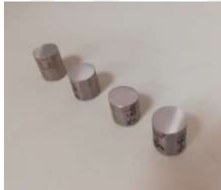
Şekil 7.12. Mikroyapı incelemeleri için yüzeyi temizlenmiş parlatılmış numuneler
