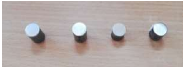
Şekil 7.22. Aşınma deneylerinin yapıldığı 18 saat yaşlandırılmış dört farklı alaşım numuneleri
