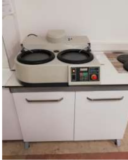
Şekil 7.11. Selçuk Üniversitesi Teknoloji Fakültesi Metalografi laboratuvarındaki Metkon marka yüzey temizleme ve parlatma cihazı
