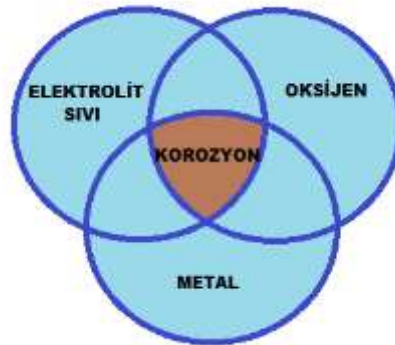
Şekil 7.24 Korozyonun temel mekanizması
