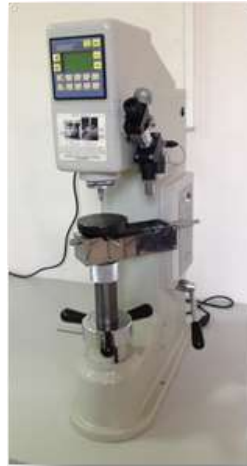
Şekil 7.17. KTÜN Metalürji ve Malzeme Bölümü Metalografi Laboratuvarındaki Brinell sertlik ölçme cihazı
