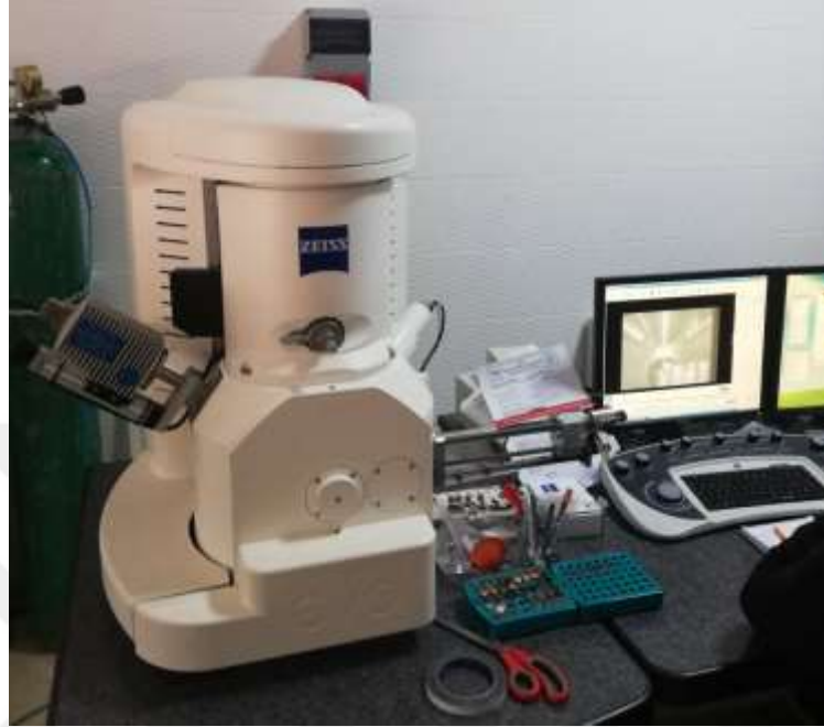
Şekil 7.15 Selçuk İltek Laboratuvarında SEM incelemelerinin yapıldığı ZEISS EVO LS10 marka Taramalı Elektron Mikroskobu
