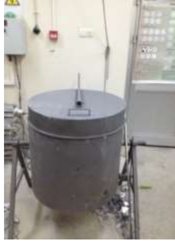
Şekil 7.2. KTÜN Metalurji ve Malzeme Bölümü Döküm Laboratuvarında deneysel çalışmalarda kullanılan 15 kg'lık potaya sahip elektrik rezistanslı ertirme ocağı
