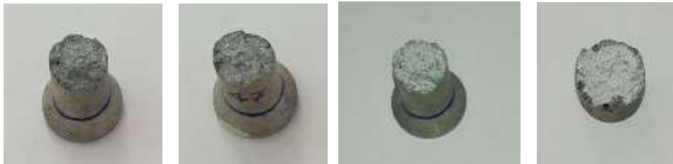
Şekil 7.13. Taramalı elektron mikroskop incelemeleri için koparılmış çekme çubuk numunelerinden hazırlanmış kırık yüzey SEM numuneleri
