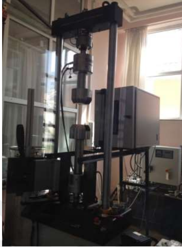
Şekil 7.19. KTÜN Makine Mühendisliği Bölümündeki INSTRON 8801 marka çekme çubuğu koparma cihazı
