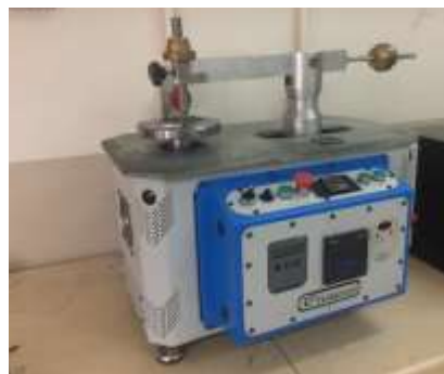
Şekil 7.23. Selçuk Üniversitesi Teknoloji Fakültesi Mekanik Laboratuvarında aşınma deneyinin yapıldığı Aşınma Test Cihazı
