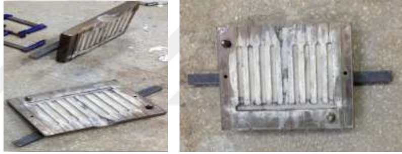
Şekil 7.4. GGG50 sfero kalite malzemedен yapılan sekizli çekme çubuk numunelerinin kalıbı
