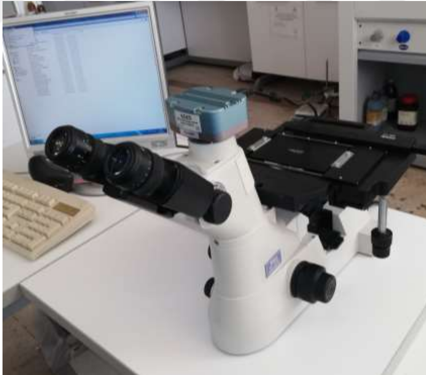
Şekil 7.14. Selçuk Üniversitesi Teknoloji Fakültesi Metalografi Laboratuvarında bu çalışmada kullanılan dört farklı Al-%5Cu alaşım numunelerinin mikro yapılarının incelendiği kameralı metal optik mikroskobu
