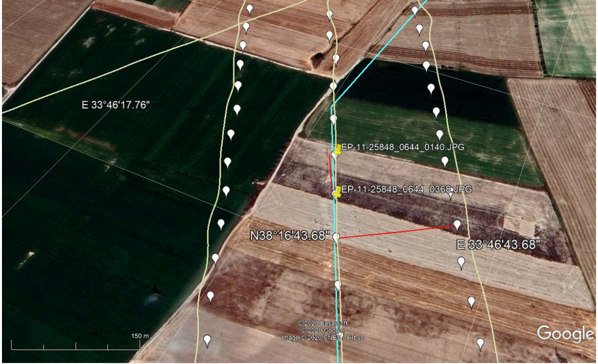
Şekil 81. Yenikent bölgesinde İHA ile gerçekleştirilen uçuş güzergahlarında çekilen ortofoto noktaları. Ortofotolar arasındaki mesafeler 50 m ve güzergahlar arasındaki mesafeler 75 m.
