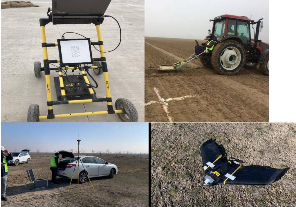
Şekil 15. Yenikent (Aksaray) bölgesi yer radarı (GPR) ölçüm çalışmalarında kullanılan GPR Cihazı ve GPR ve İnsansız hava aracı (İHA) Ölçüm çalışmaları
