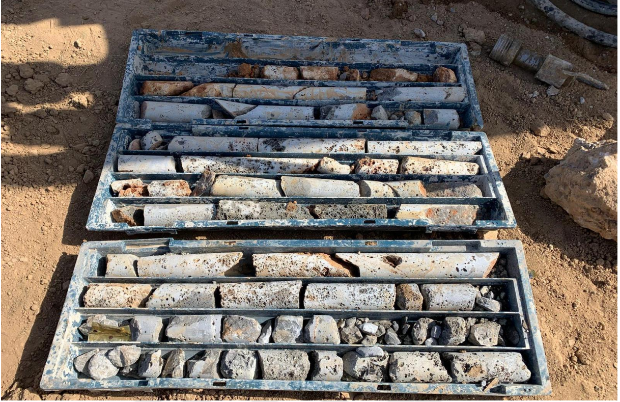
Şekil 23. Karot sandıklarına yerleştirilen karotların görünümü (SK-3)
