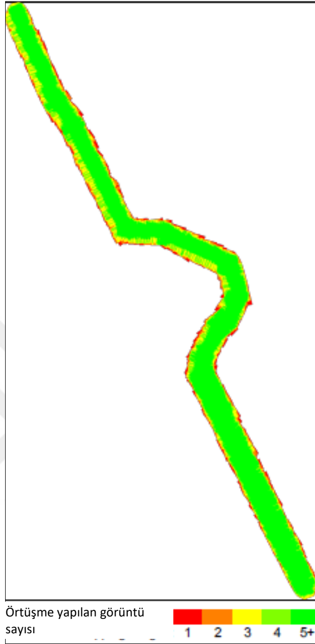
Şekil 82. İHA ölçümlerinde görüntü eşleştirmesi yapılan ortofotolarda örtüşme oranları; kırmızı renkler düşük örtüşmeyi gösterirken yeşil alanlarda her piksel için 5'ten fazla görüntü çakışmaktadır.
