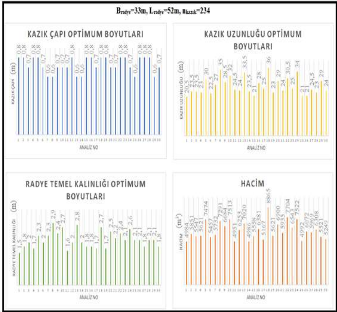
Şekil 8.47. Analiz sonucu elde edilen optimum temel boyutları ve hacim değerleri ( B_{\text{radye}}=33\text{m} , L_{\text{radye}}=52\text{m} , n_{\text{kazık}}=234 )
