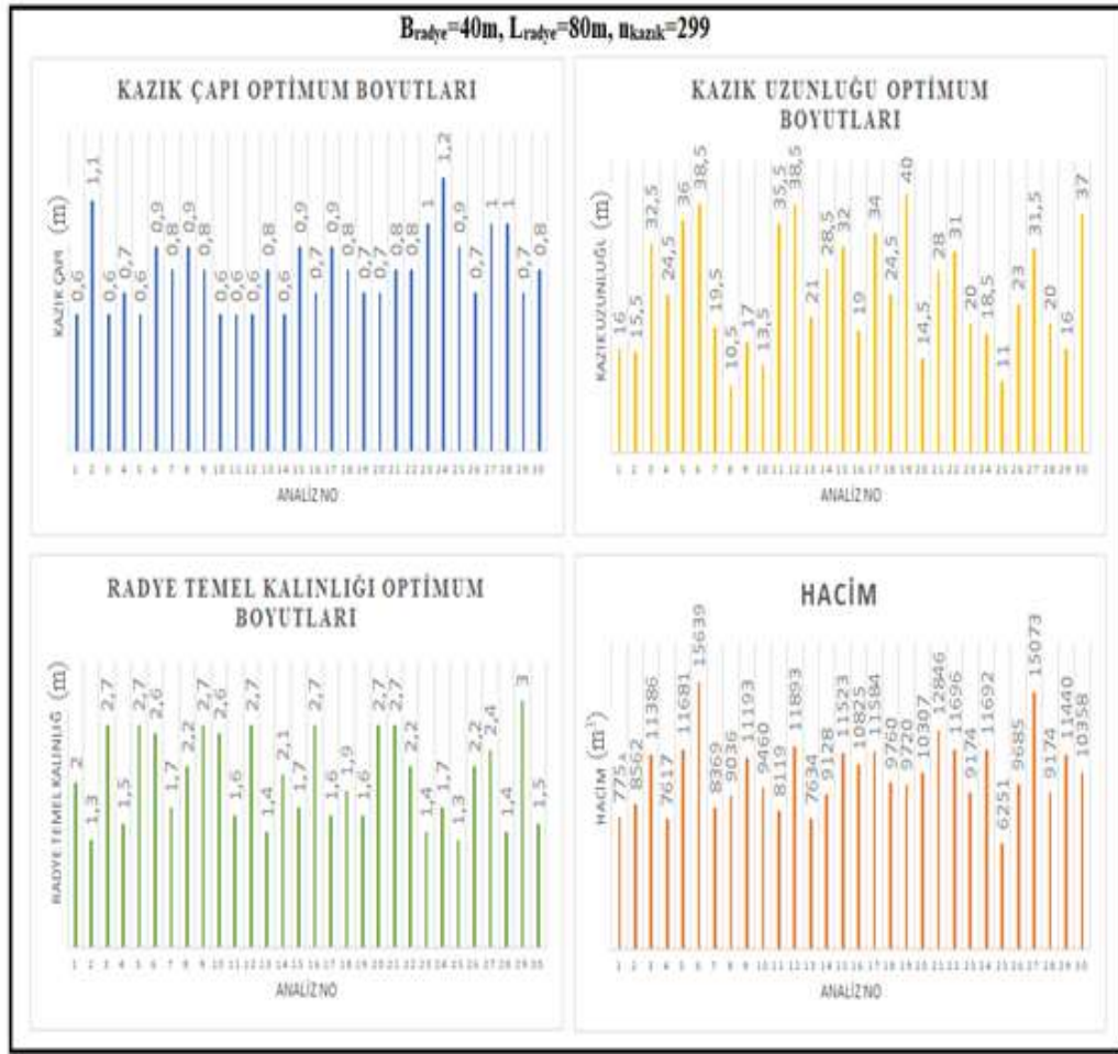
Şekil 8.11. Analiz sonucu elde edilen optimum temel boyutları ve hacim değerleri ( B_{\text{radye}}=40\text{m} , L_{\text{radye}}=80\text{m} , n_{\text{kazık}}=299 )
