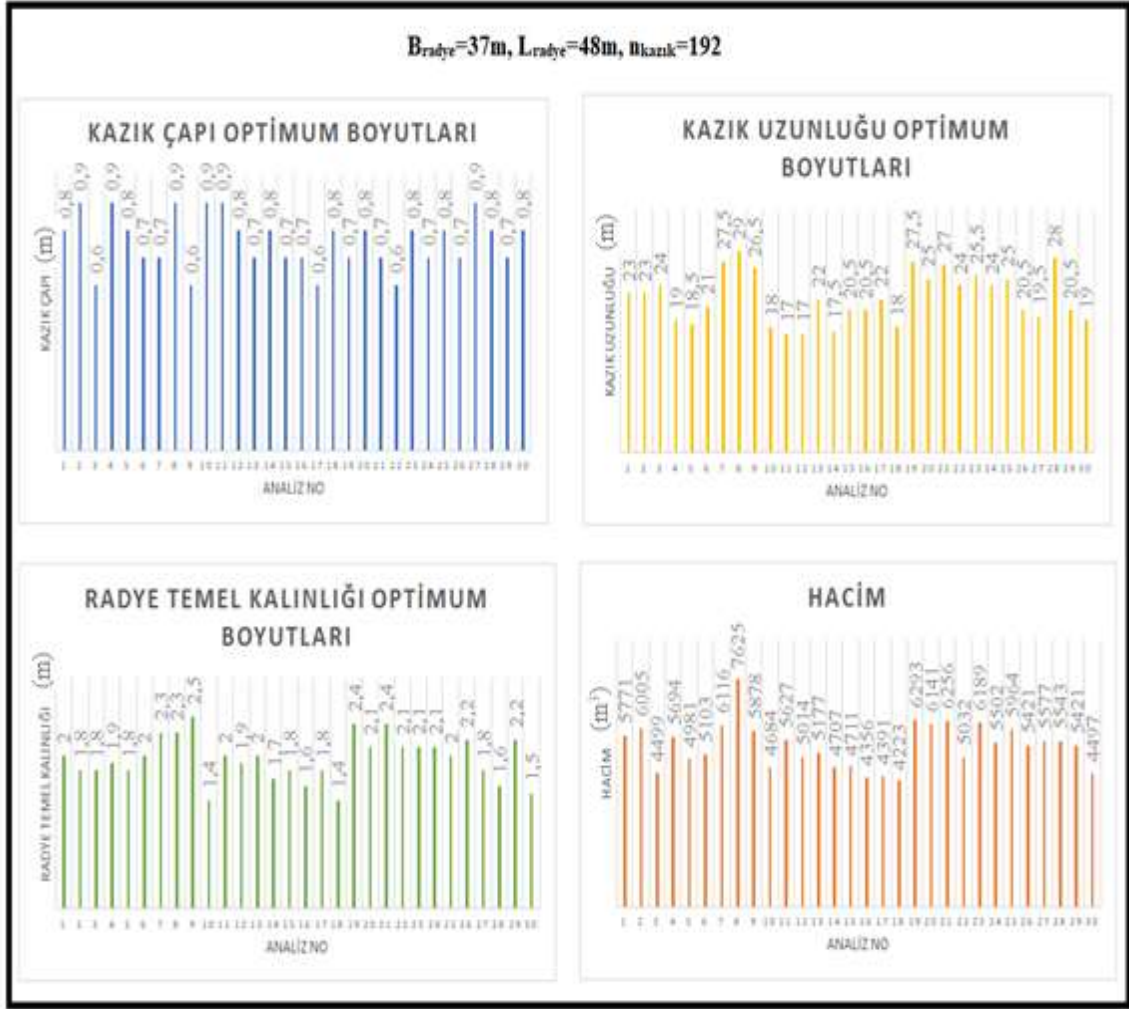
Şekil 8.52. Analiz sonucu elde edilen optimum temel boyutları ve hacim değerleri ( B_{\text{radye}}=37\text{m} , L_{\text{radye}}=48\text{m} , n_{\text{kazık}}=192 )
