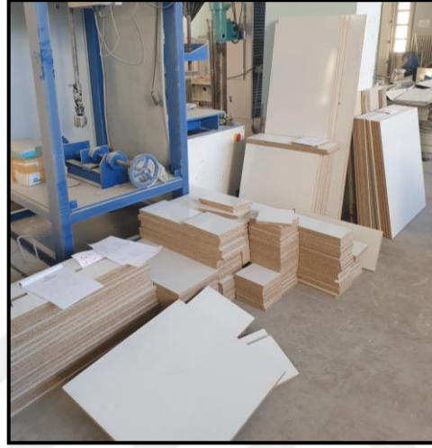
Şekil 5. 13 Metraj hesaplamaları sonucu ölçülere göre kesilen kalıp parçaları
