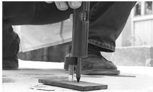
Şekil 3. 4 Sondanın beton yüzeyi dışında kalan kısmının ölçülmesi (Erdal ve Şimşek,2006)
