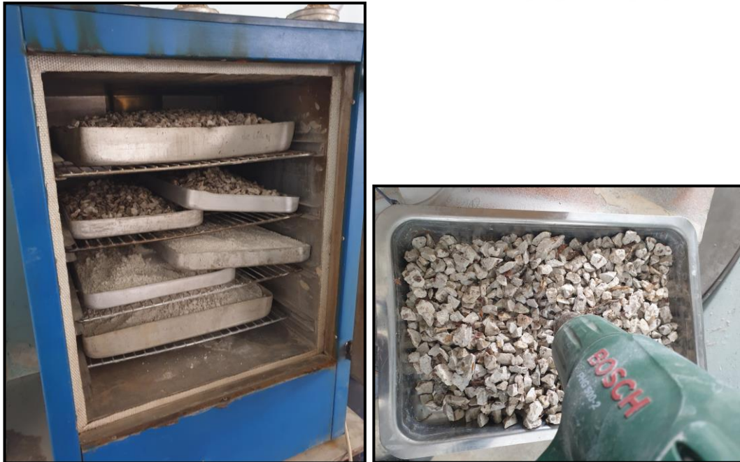
Şekil 5. 29 Etüv fırında ve kurutma makinesinde agrega ve kumun kurutulması
