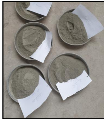
Şekil 5. 31 Beton karışımı için tartımı yapılan çimentolar
