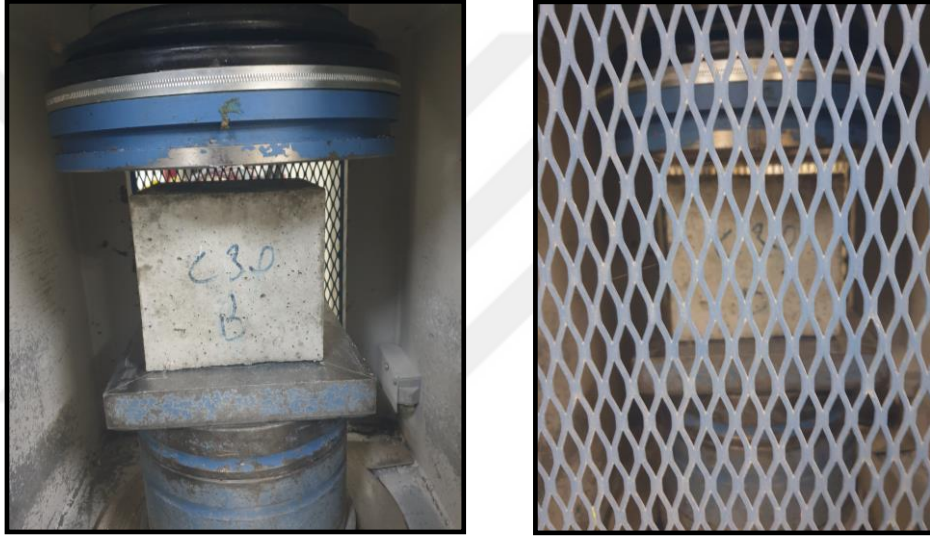
Şekil 5. 37 Beton basınç deneylerinin yapılması
