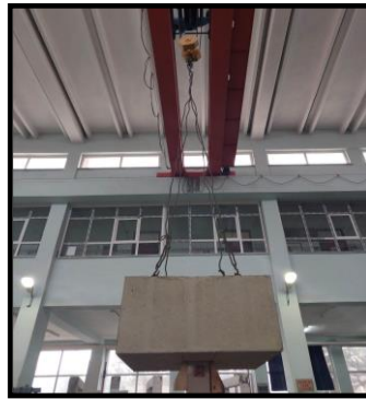
Şekil 6. 2 Vinç yardımı ile yerleştirilen beton kütle
