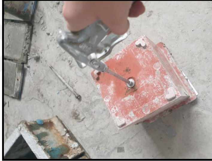
Şekil 5. 36 Küp numunelerin kalıplardan çıkartılması
