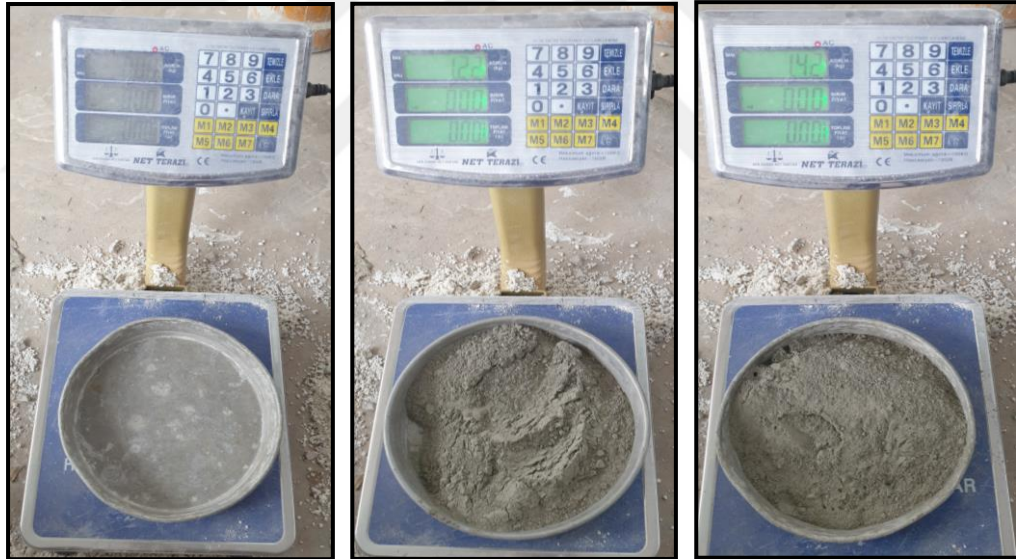
Şekil 5. 30 İri ve ince (kum) agregaların beton dökümü için hazırlanması
