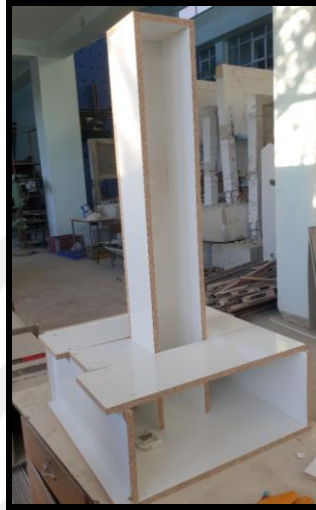
Şekil 5. 16 Temel kalıbı ve kolon kalıbının birleşim öncesi görüntüsü
