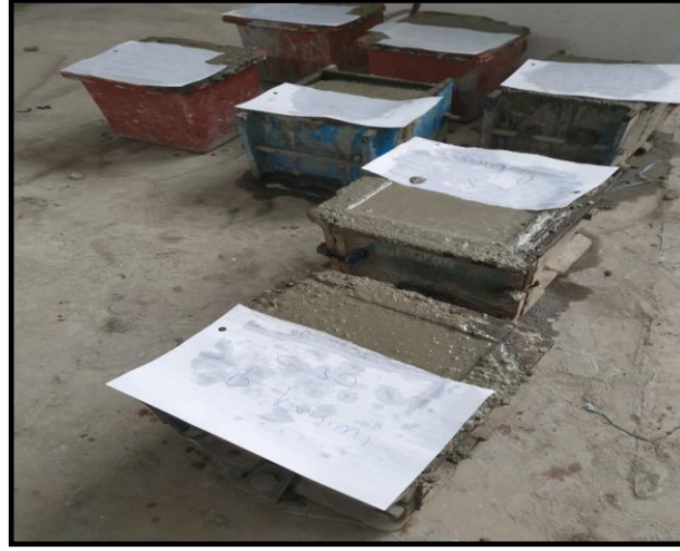
Şekil 5. 35 Beton karışımının küp numunelere yerleşimi
