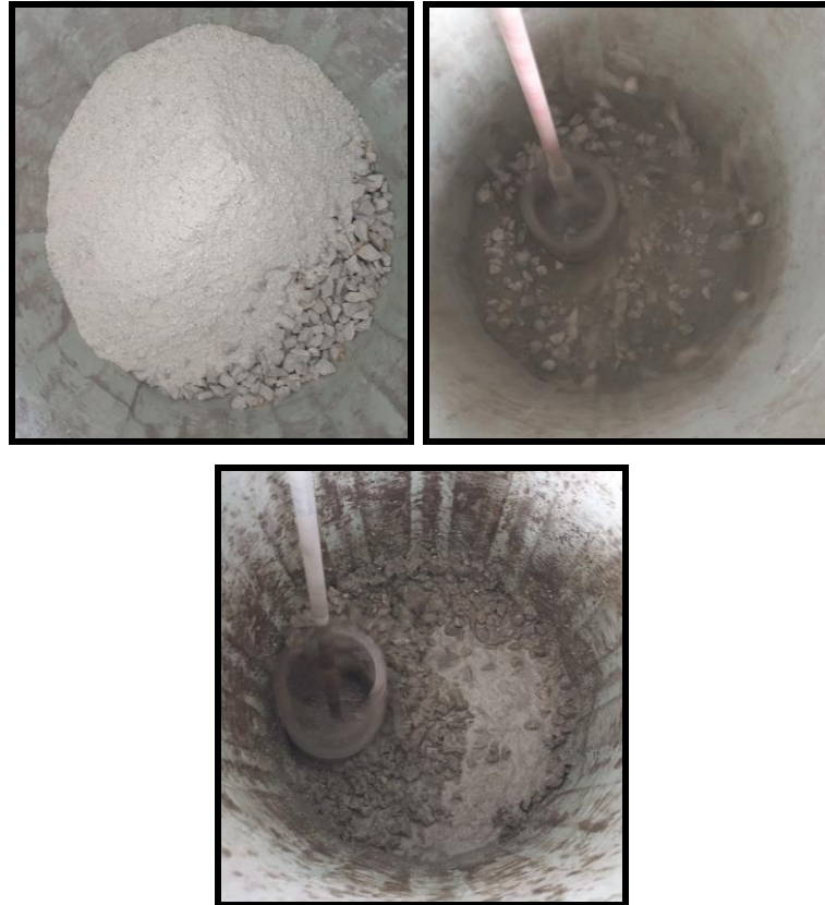
Şekil 5. 33 Beton karışımının hazırlanması
