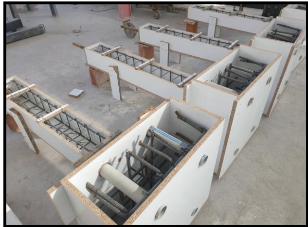
Şekil 5. 26 Numunelere yerleştirilen tij ile birlikte beton dökümü öncesi numunelerin son hali
