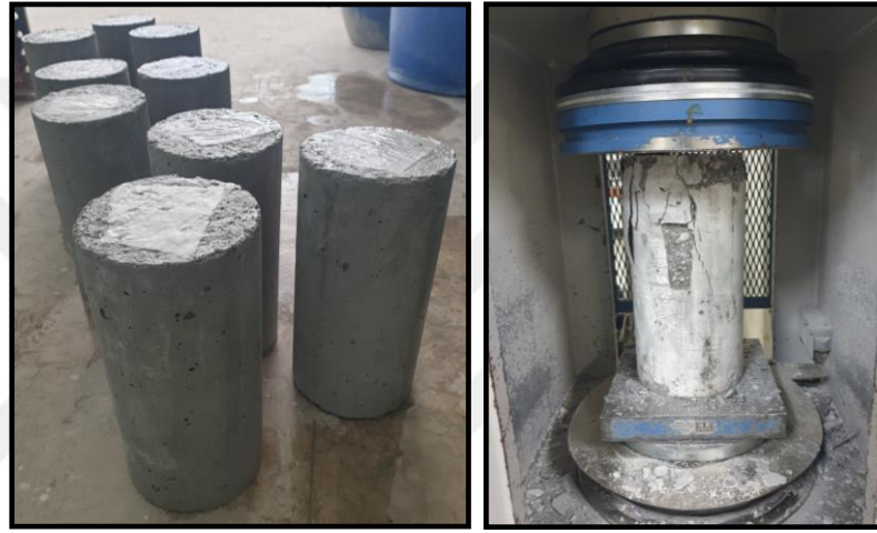
Şekil 5. 47 Silindir numunelerin 28 gün sonunda dayanımlarının elde edilmesi
