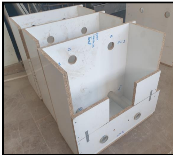
Şekil 5. 17 Pvc borular için kalıplarda açılan daireler
