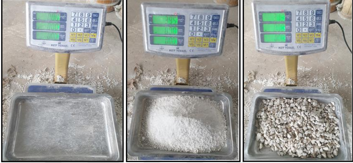
Şekil 5. 30 İri ve ince (kum) agregaların beton dökümü için hazırlanması
