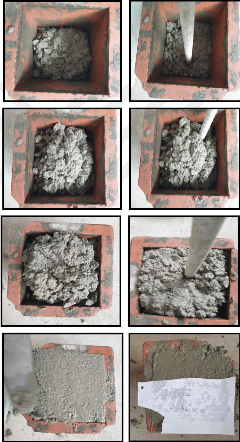
Şekil 5. 34 Beton karışımının küp numunelere homojen olarak yerleştirilmesi
