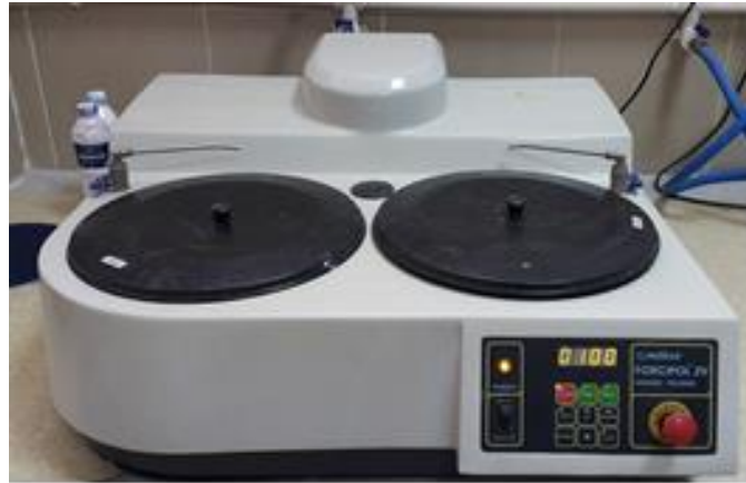
Şekil 3. 2. Metkon Forcİpol 2v zımpara cihazı
