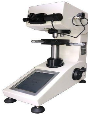
Şekil 3. 5. Microbul 1000-DN Micro Vickers sertlik ölçüm cihazı
