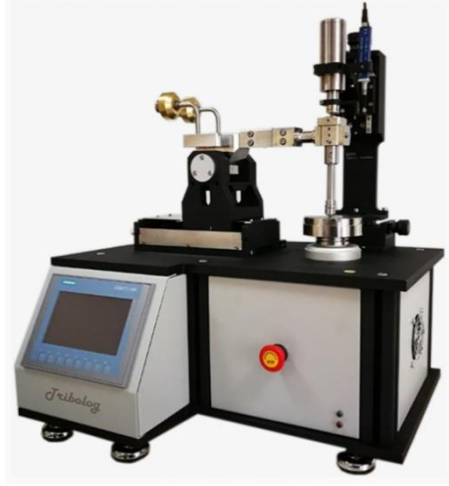
Şekil 3. 6. Aşınma testlerinde kullanılan UTS Tribolog aşınma test sistemi
