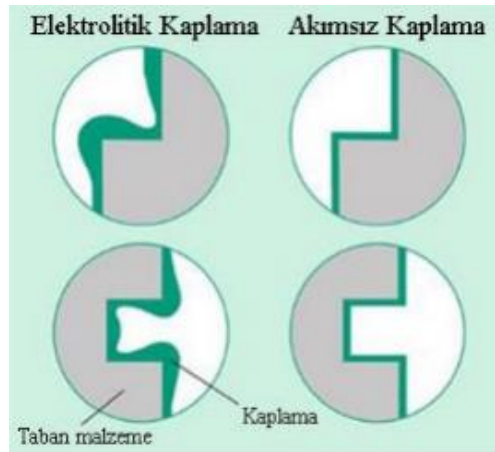
Şekil 2. 9. Akımlı (electrolytic) ve akımsız (electroless) kaplamalarda kalınlık dağılımı (Eraslan, 2010)
