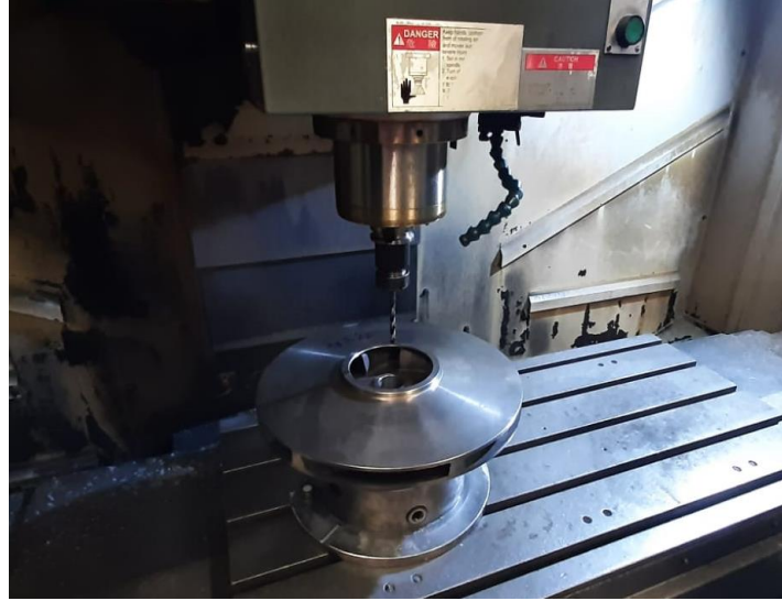
Şekil 3.3. Dengeleme Deliklerinin Delinmesi
