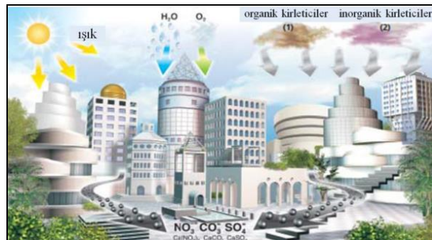
Şekil 2.33. Kentsel alanlarda fotokatalitik beton kullanımı (İtalcementi Group, 2022a)
