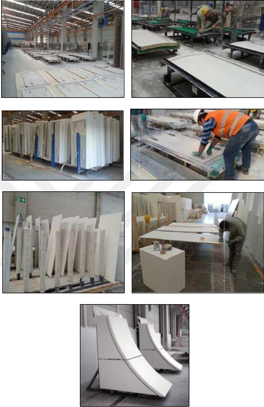
Şekil 2.80. Kendini temizleyen fotokatalitik panellerin üretim aşaması (Delibaş ve Maraşlı, 2015; Maraşlı, 2022)
