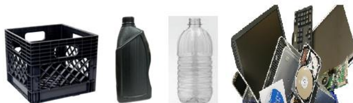
Şekil 3.1. Tez kapsamında kullanılan plastik atıklar (Soldan sağa doğru: PP Siyah kasa, YYPE Siyah bidon, PET şişe, PS elektronik cihaz atığı) (Anonim, 2021)
