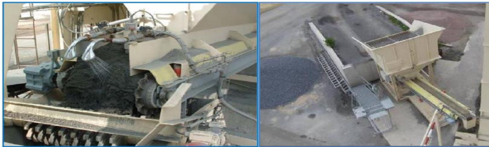
Şekil 2.11. LEA yönteminde ince agreganın nemlendirilerek karışıma dahil edilmesi (Prowell ve ark., 2012)
