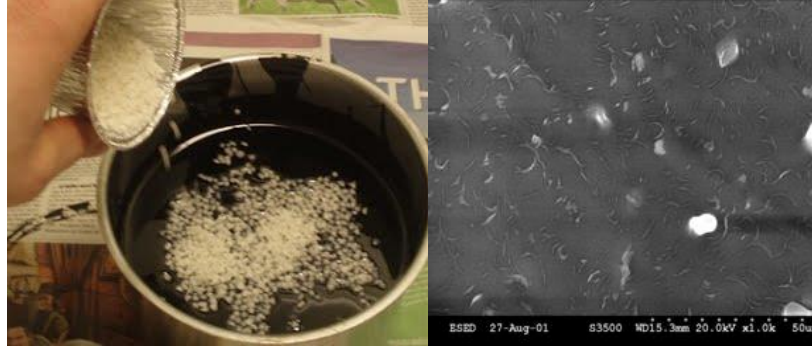
Şekil 2.15. Sasobit® genel görünüm (solda), katılaştıktan sonra oluşan ağsı yapı (sağda) (Butz, 2008)
