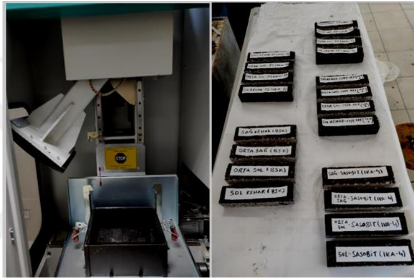
Şekil 4.92. Slab compactor (solda), TSRST numuneleri (sağda)
