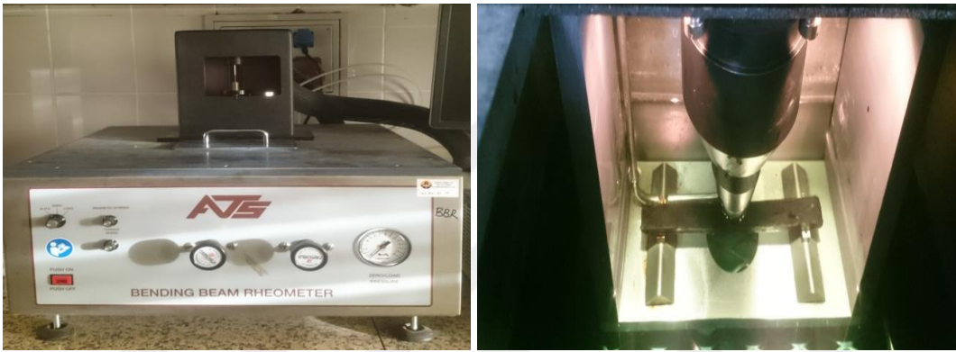
Şekil 3.14. ATS BBR 2S test cihazı (solda) ve numunenin test edilişi (sağda)
