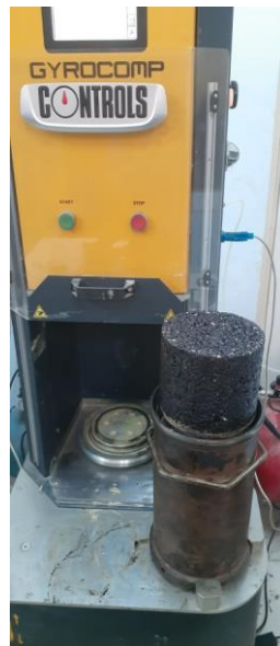
Şekil 3.19. Controls marka yağürmalı sıkıştırma cihazı ve üretilen bir numune
