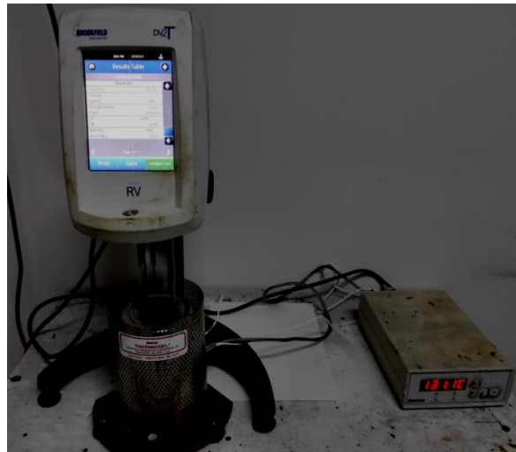
Şekil 3.9. Brookfield viskozimetre test cihazı
