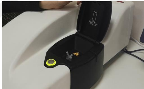
Şekil 3.6. Malvern Zeta Sizer test cihazı
