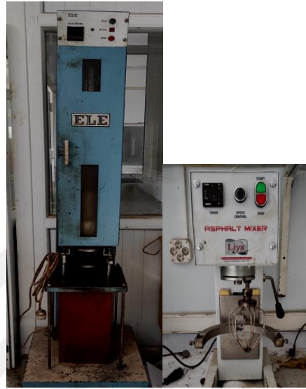
Şekil 3.15. Marshall tokmağı (solda) ve asfalt mikseri (sağda)
