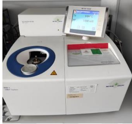
Şekil 3.7. Tez kapsamında kullanılan DSC analiz cihazı
