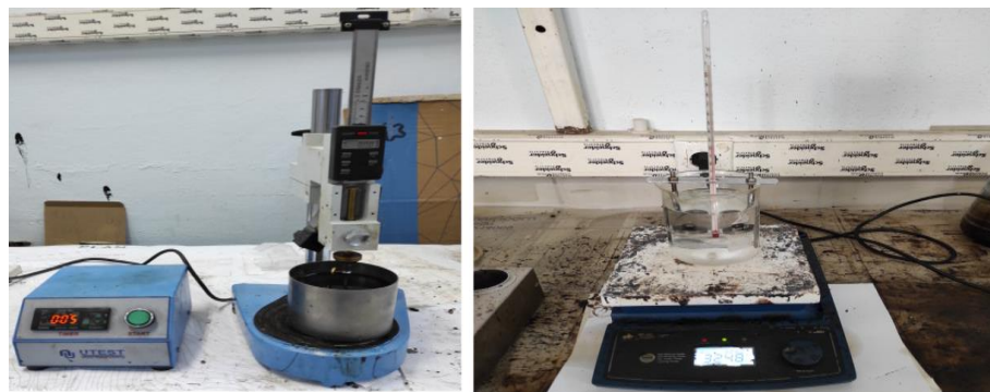
Şekil 3.8. Penetrasyon (solda) ve yumuşama noktası (sağda) test cihazları
