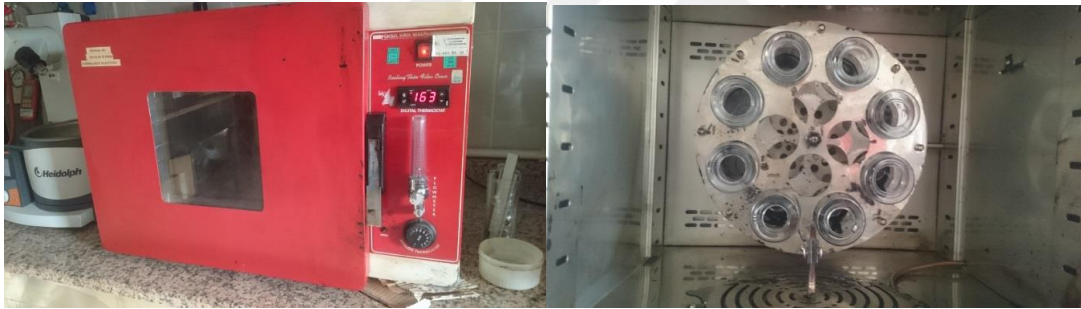
Şekil 3.11. RTFOT cihazı dış (solda) ve iç görünümü (sağda)
