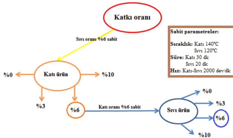
Şekil 4.36. YYPE-PET katkıli bitümlerde katkı oranı tayini için hazırlanan deney akış şeması
