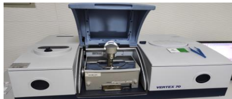
Şekil 3.4. Bruker Vertex 70 FTIR ATR Spektroskopisi test cihazı
