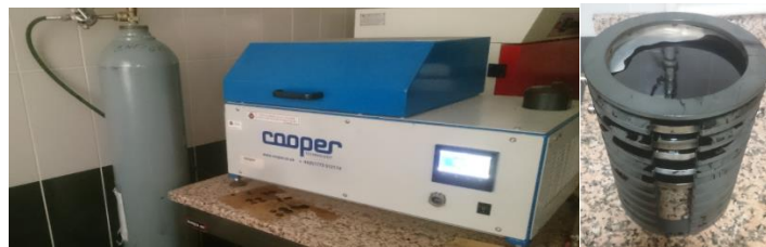
Şekil 3.12. PAV deney cihazı (solda) ve konulan numuneler (sağda)
