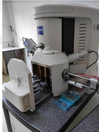
Şekil 3.5. Zeiss EVO LS 10 SEM analiz cihazı
