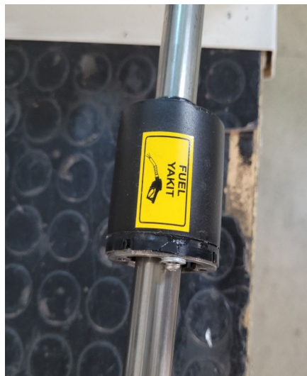
Şekil 3.34. MSV yakıt seviye şamandırası
