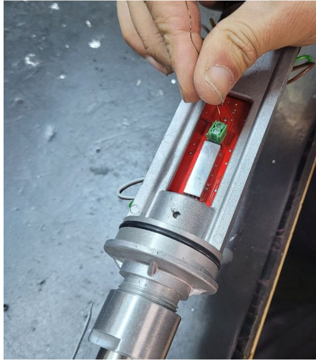
Şekil 3.36. MSV kablo montajı
