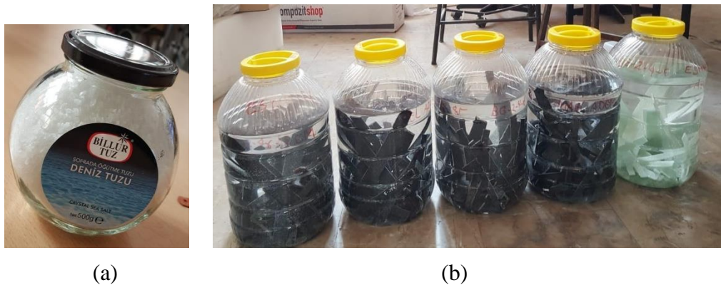
Şekil 3.9. a) Kristal Deniz Tuzu ve b) Tuzlu suya batırılmış numuneleri içeren kavanozlar
