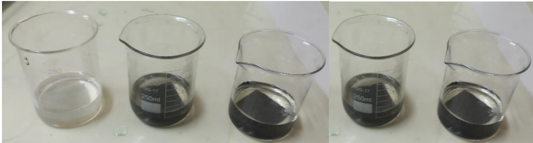
Şekil 3.5. Kompozit Numuneler, 50 mL %70 nitrik asit içeren bir behere yerleştirildi.
