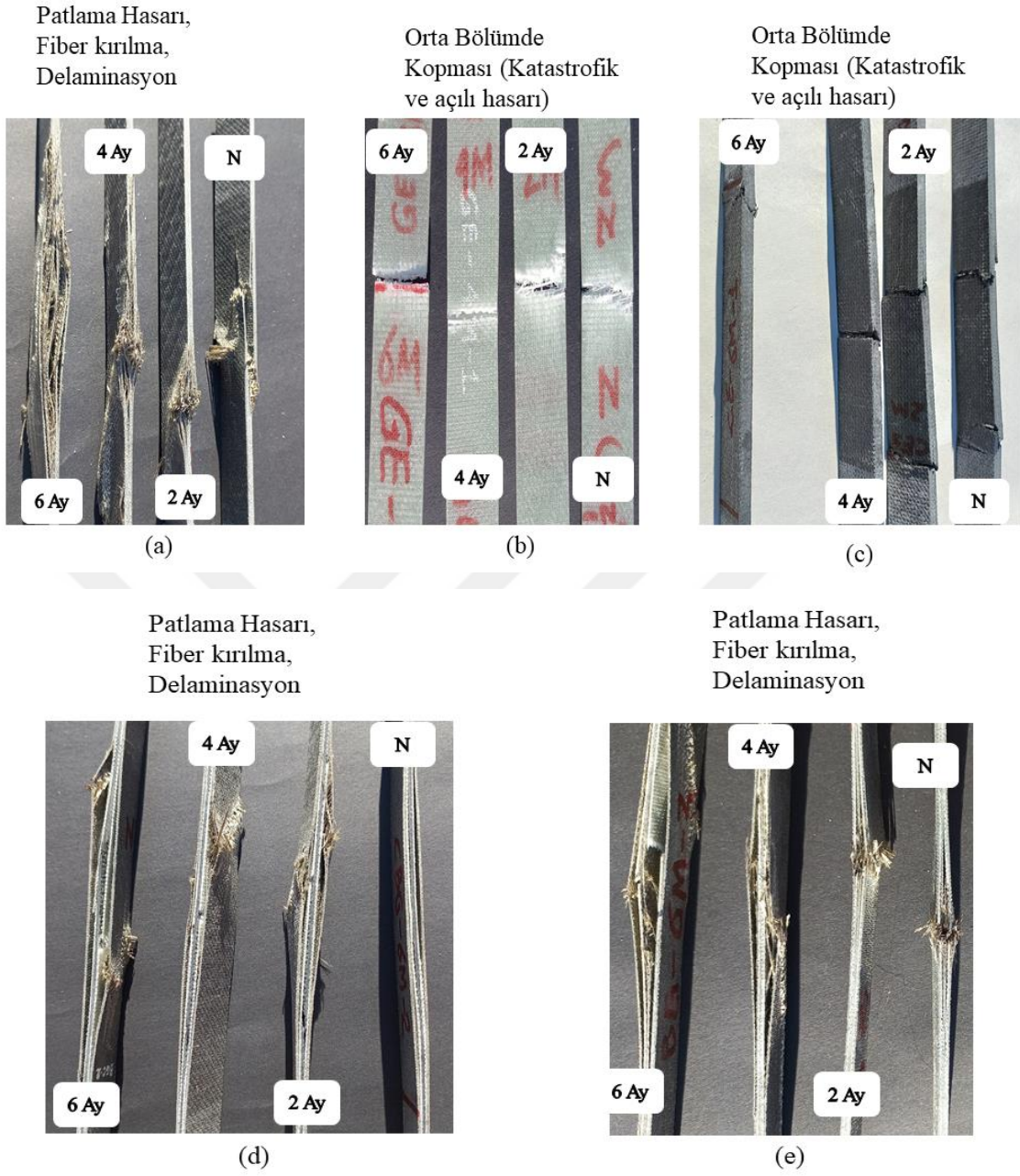
Şekil 4.10. Kompozitlerin Çekme Hasarı Modları: a) BE, b) GE, c) CE, d) BCGE, ve e) BGE
