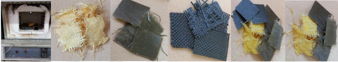
Şekil 3.7. Hacim İçeriklerinin Hesaplanmasında Kullanılan Yıkanmış Numunelerin ve Kurutulmuş Liflerin Kurutulmasında Kullanılan Fırın
