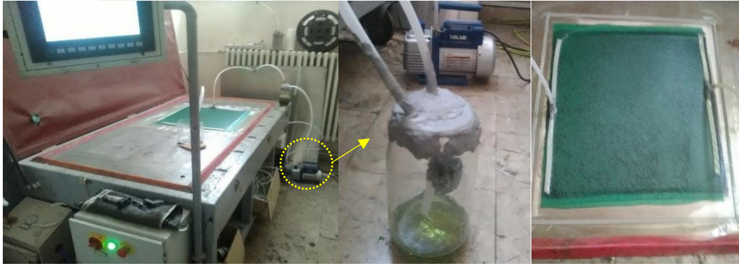
Şekil 3.4. Laboratuvardaki kompozit üretim (VARTM) ünitesi
