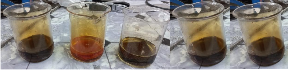
Şekil 3.6. Yıkamadan Önce Nitrik Asitle Sindirilmiş Kompozitler İçeren Beherler
