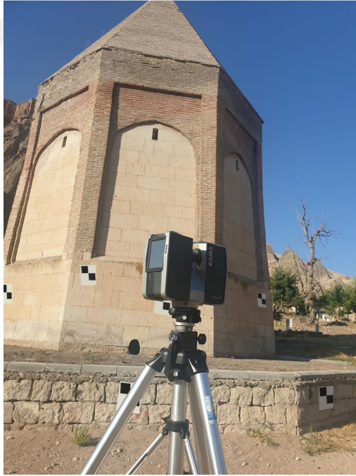
Şekil 4.5. Türbenin Cephe Taramasının Yapılması
