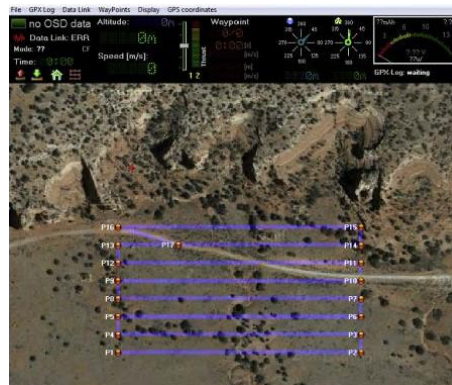
Şekil 3.11. Uçuş planı hazırlayan ve yöneten MikroKopter ve CineStar8 yazılımı (Casana et al. 2014).
