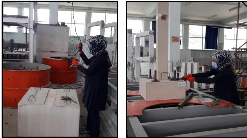
Şekil 5.18. Deney numunelerinin sarsma tablasına kurulumu
