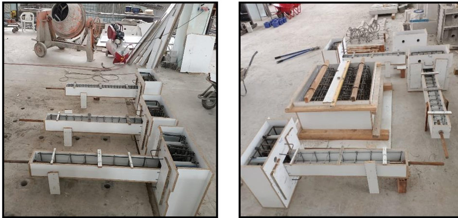
Şekil 5.14. Beton dökümünden önce deney numunelerinin görünümü
