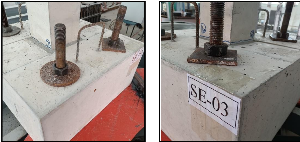
Şekil 6.16. SE-03 deney numunesinde test sonucunda oluşan çatlaklar
