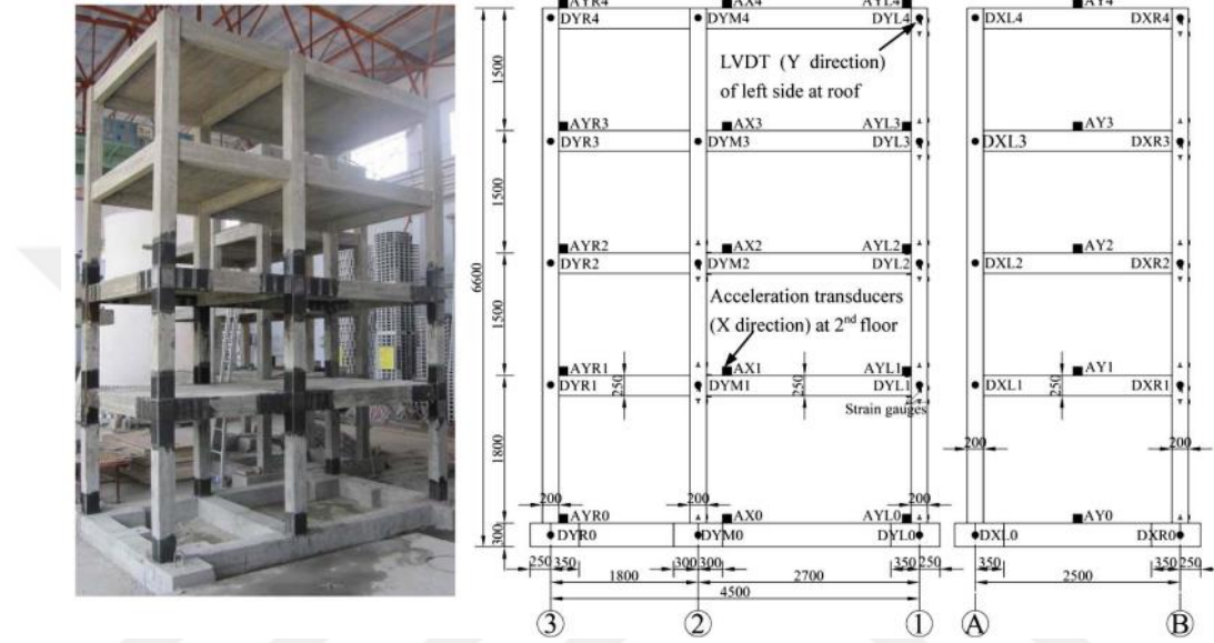
Şekil 2.20. CFRP ile güçlendirilmiş çerçeve ve çerçevenin genel şematik görüntüsü (Wang ve ark., 2017)
