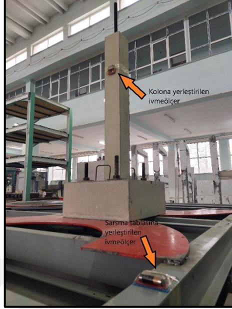
Şekil 5.24. Deneyde kullanılan ivmeölçerlerin konumları
