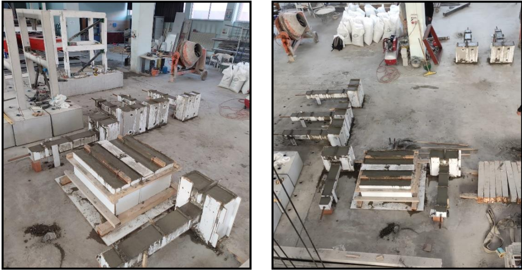
Şekil 5.16. Beton döküldükten sonra deney numunelerinin görünümü
