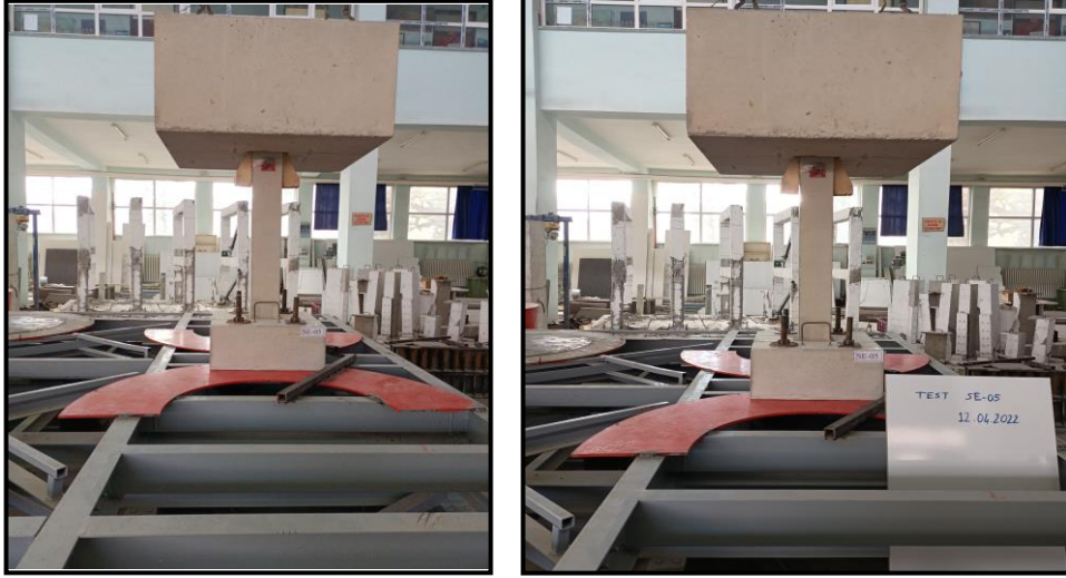
Şekil 6.29. Deneye başlamadan önce SE-05 deney numunesinin sarsma tablası üzerinde genel görünümü
