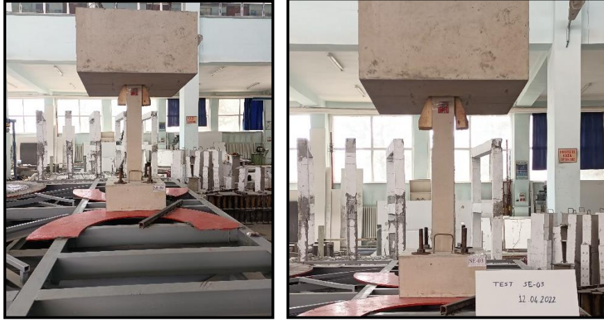
Şekil 6.15. Deneye başlamadan önce SE-03 deney numunesinin sarsma tablası üzerinde genel görünümü
