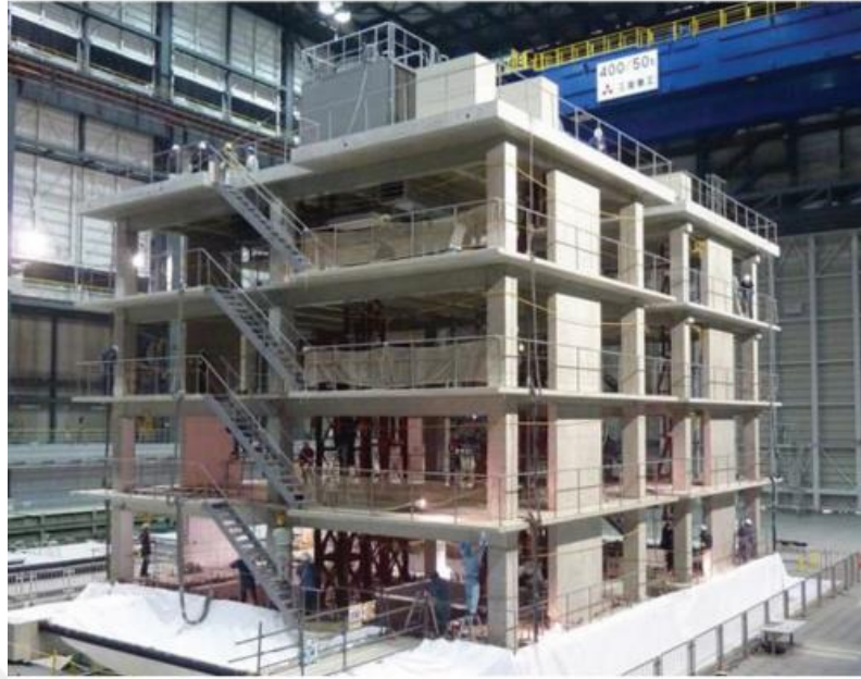
Şekil 2.18. E-Defense sarsma tablasında betonarme (solda) ve öngerilmeli beton (sağda) numuneler (Nagae ve ark., 2015)
