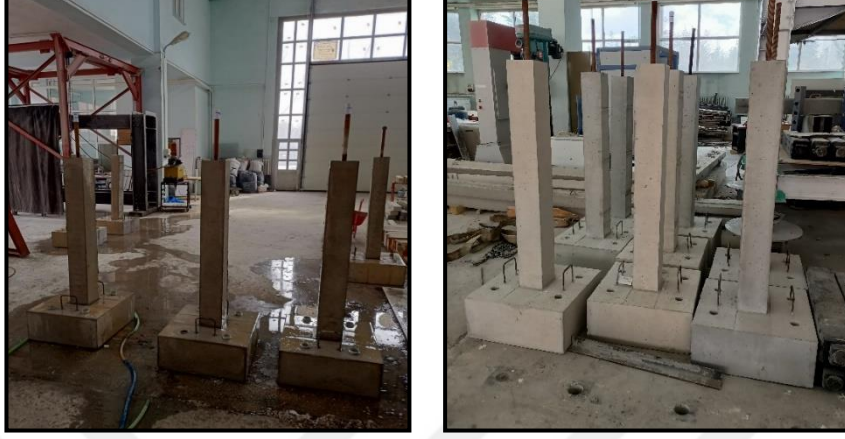
Şekil 5.17. Kalıplardan çıkarılmış deney numuneleri ve küreleme işlemi
