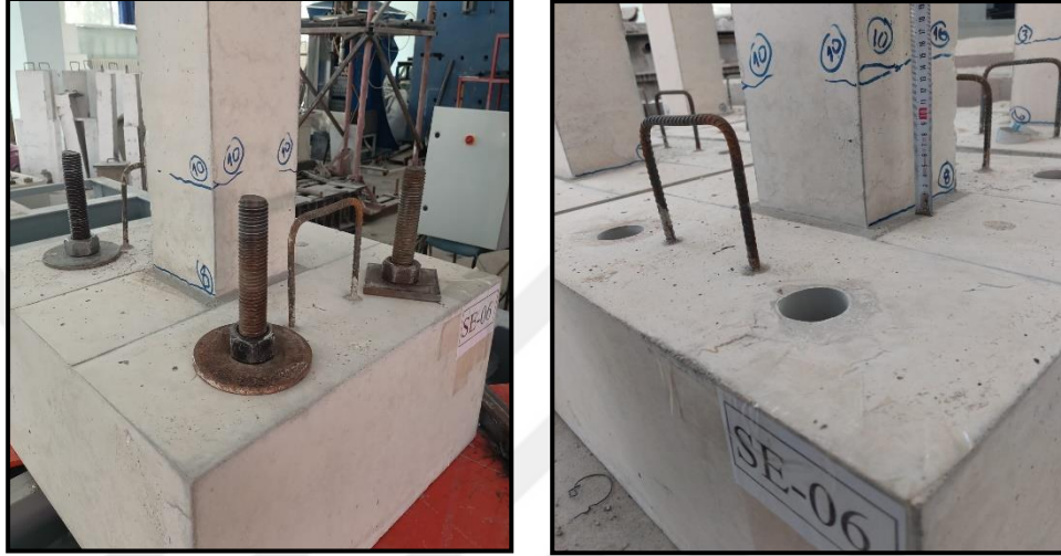
Şekil 6.37. SE-06 deney numunesinde test sonucunda oluşan çatlaklar
