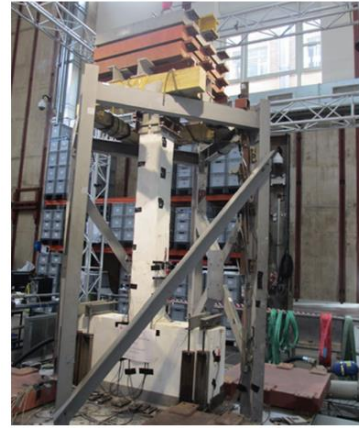
Şekil 2.10. Deney numunelerinin detayları ve sarsma tablasına test kurulumu (Kashani ve ark., 2019)
