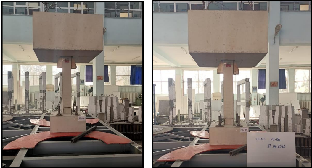
Şekil 6.36. Deneye başlamadan önce SE-06 deney numunesinin sarsma tablası üzerinde genel görünümü
