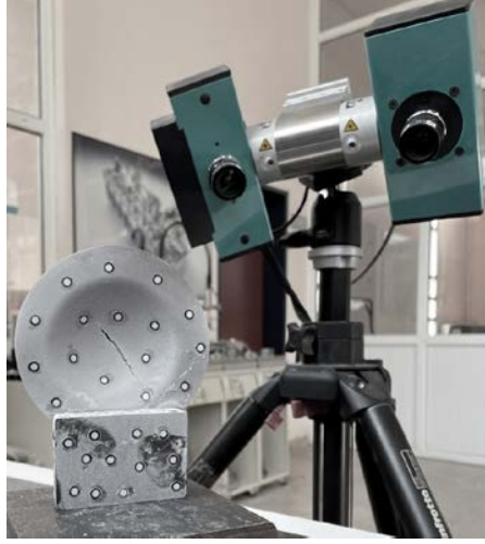
Şekil 3.40. Hasar meydana gelen numunenin 3B optik taraması
