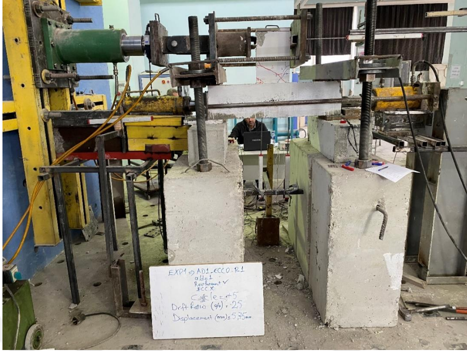
Şekil 4.2. AD1-ECC0-R1 deney elemanında oluşan ilk çatlaklar
