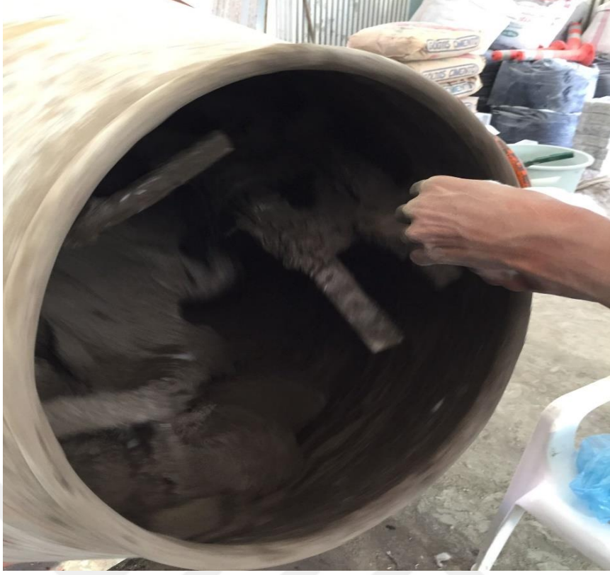
Şekil 3.14. PVA lifli beton karışımının hazırlanması
