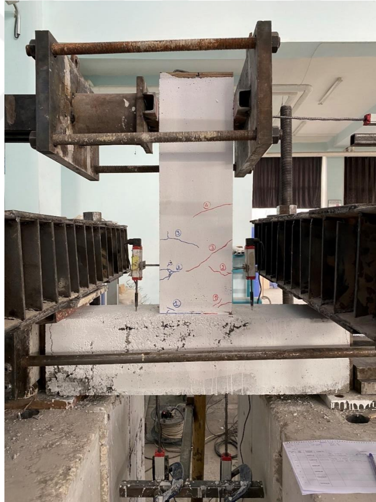
Şekil 4.21. AD3-ECC0-R1 deney elemanında oluşan ilk çatlaklar
