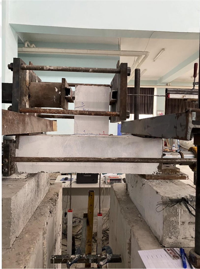
Şekil 4.30. AD1-ECC1-R0 deney elemanında oluşan ilk çatlaklar
