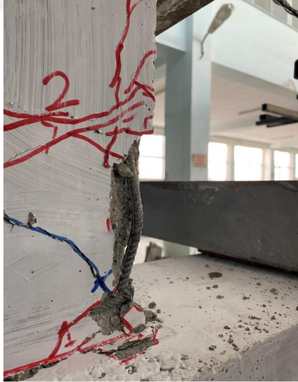
Şekil 4.12. AD2-ECC0-R1 deney elemanında donatı burkulması
