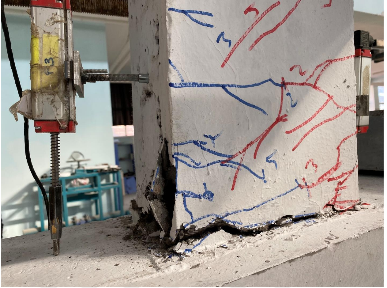
Şekil 4.64. AD2-ECC1-R1 deney elemanında basınç bölgesindeki donatı burkulması
