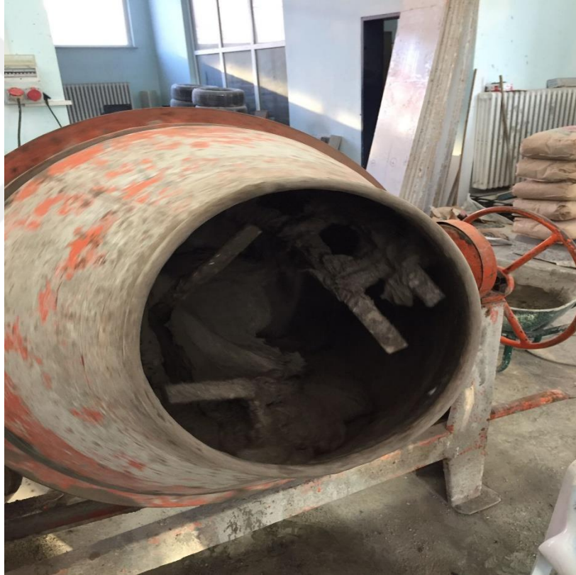
Şekil 3.13. Beton karışımının hazırlanması
