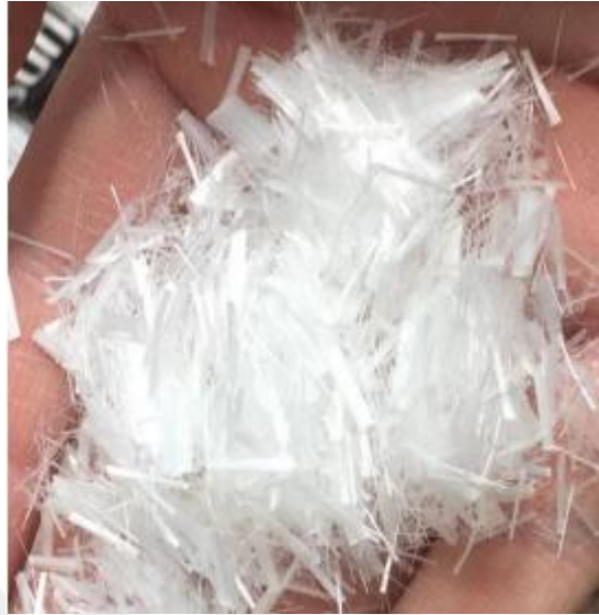
Şekil 3.3. Lif donatılı harç karışımlarında kullanılan PVA liflerinin görüntüsü
