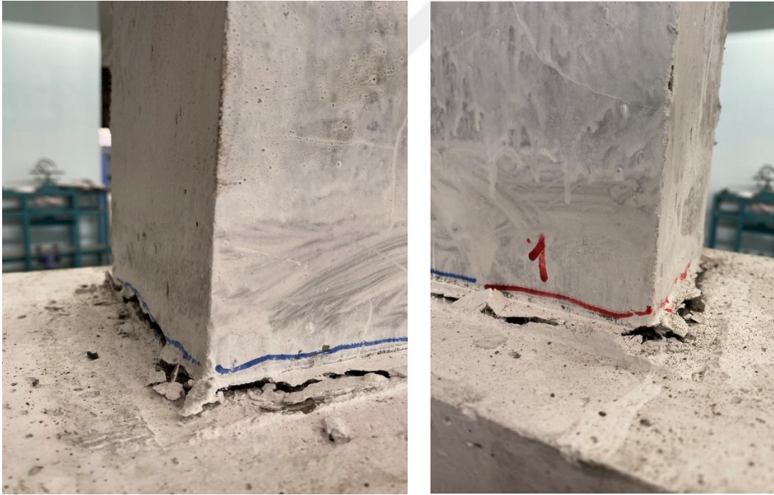
Şekil 4.40. AD2-ECC1-R0 deney elemanın deney sonundaki hasarları
