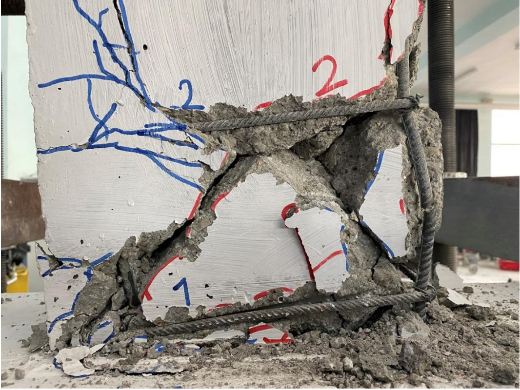
Şekil 4.15. AD2-ECC0-R1 elemanın deney sonundaki hasarları
