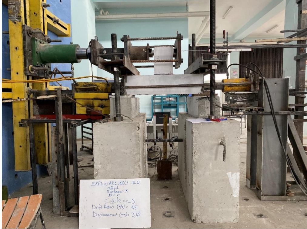
Şekil 4.31. AD1-ECC1-R0 elemanının deney sonundaki görünümü
