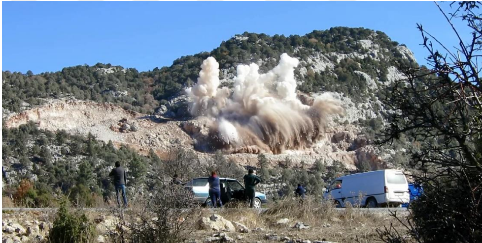
Şekil 2.2. Patlatma esnasında açığa çıkan tozların görüntülenmesi (Anonim, 2016)
