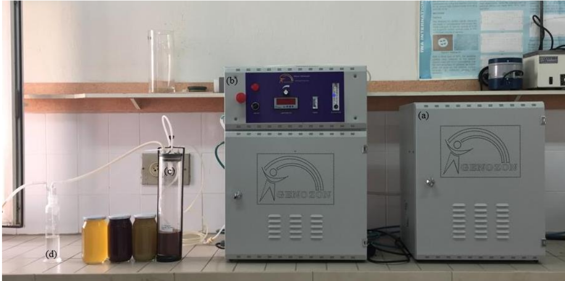
Şekil 3.3. Ozonlama sisteminin şematik görüntüsü: (a) kuru hava ve O 2 zenginleştirme ünitesi, (b) ozon jeneratörü, (c) temas reaktörü, (d) KI yıkama şişesi
