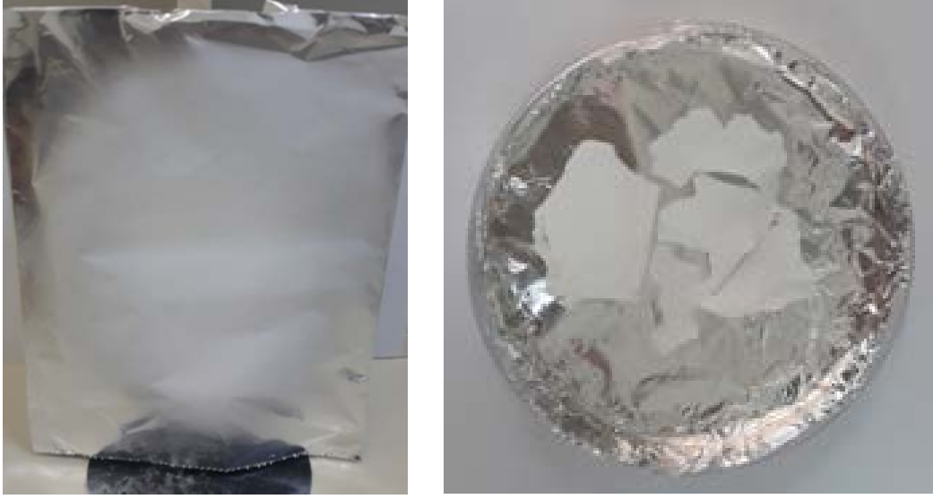
Şekil 3.3: a) Püskürme işlemi sonunda alüminyum folyo plakası üzerinde biriken fiberlerin ısı işlem öncesi görüntüsü, b) ısı işlem sonrası görüntüsü.
