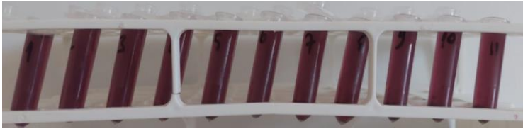
Şekil. 3.9 Portakal kabuğundan elde edilen ekstraktlara yapılan DPPH antioksidan aktivite analizinde renk gelişimi
