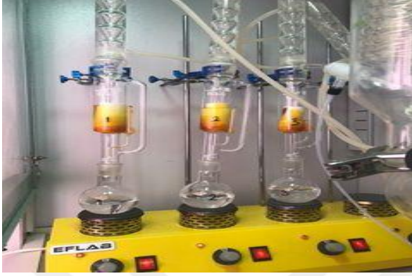
Şekil 3.4 Portakal kabuğu numunelerinin ekstraksiyonunda kullanılan soxhlet düzeneği
