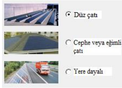
Şekil 3.22. Fotovoltaik panellerin yerleştirileceği zemin özellikleri
