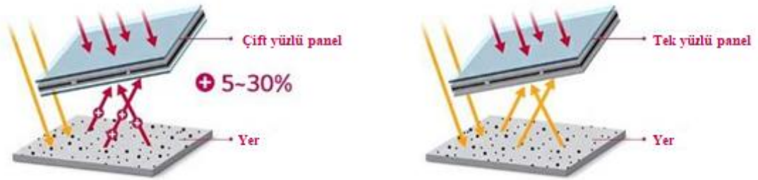
Şekil 1.20. Çift yüzlü fotovoltaik panele ve Tek yüzlü fotovoltaik panele gelen ışınlar
