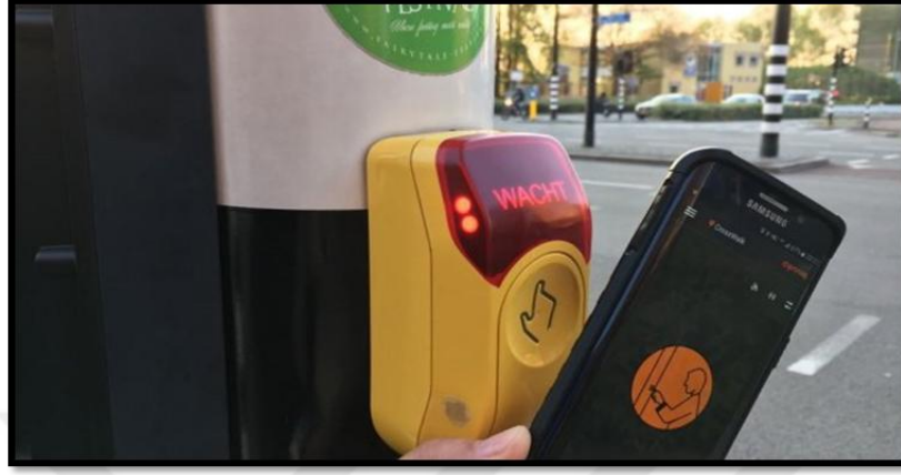
Şekil 2.5. Trafik ışıklarında bulunan Sensör ve Crosswalk mobil uygulama koordinasyonu (URL 6).
