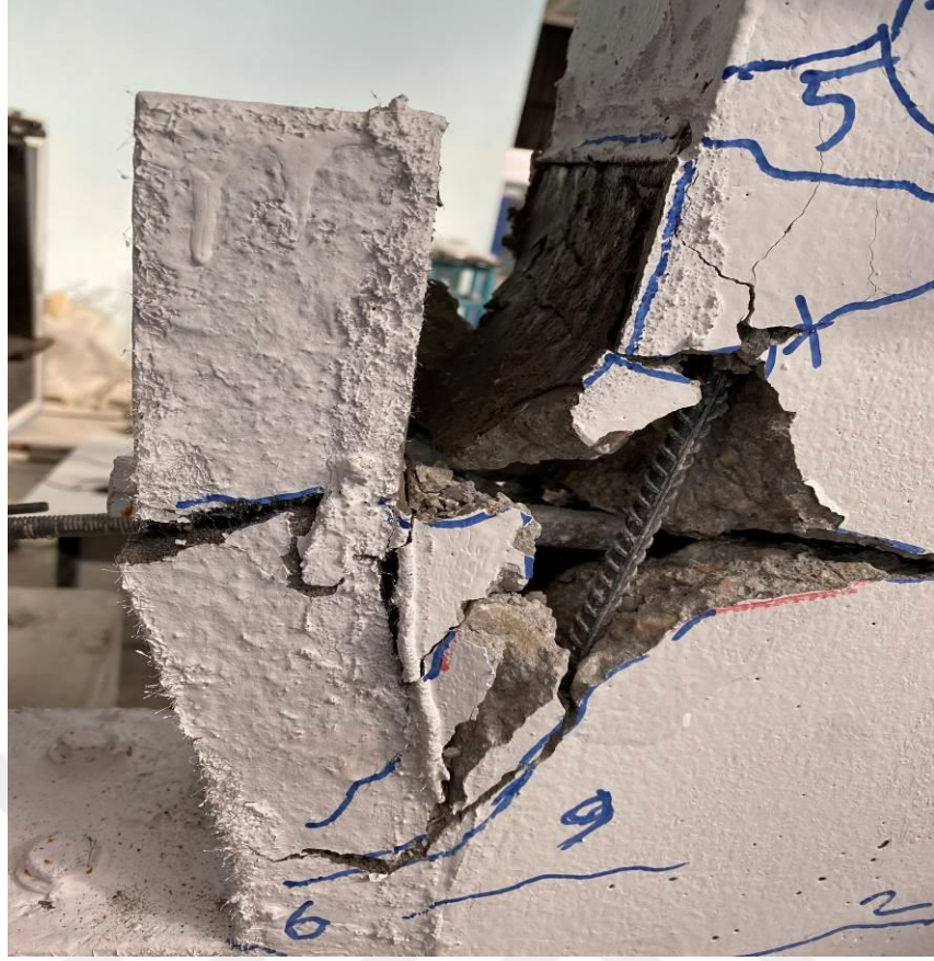
Şekil 4.26. RB-LDB1-SEW deney elemanında basınç bölgesinde görülen hasar
