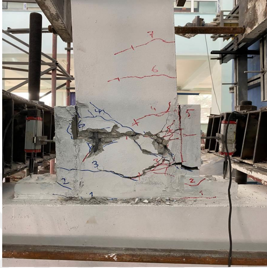
Şekil 4.68. RB- LDB2-SEW deney elemanın son durumdaki çatlak dağılımı
