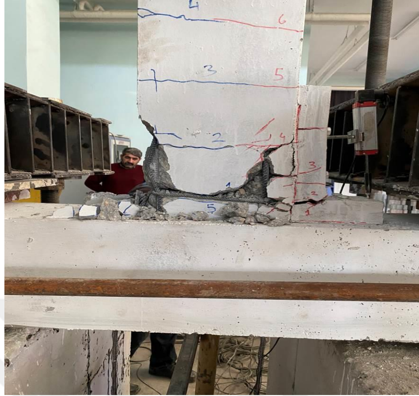
Şekil 4.57. RB- LDB2-SE deney elemanın son durumdaki çatlak dağılımı
