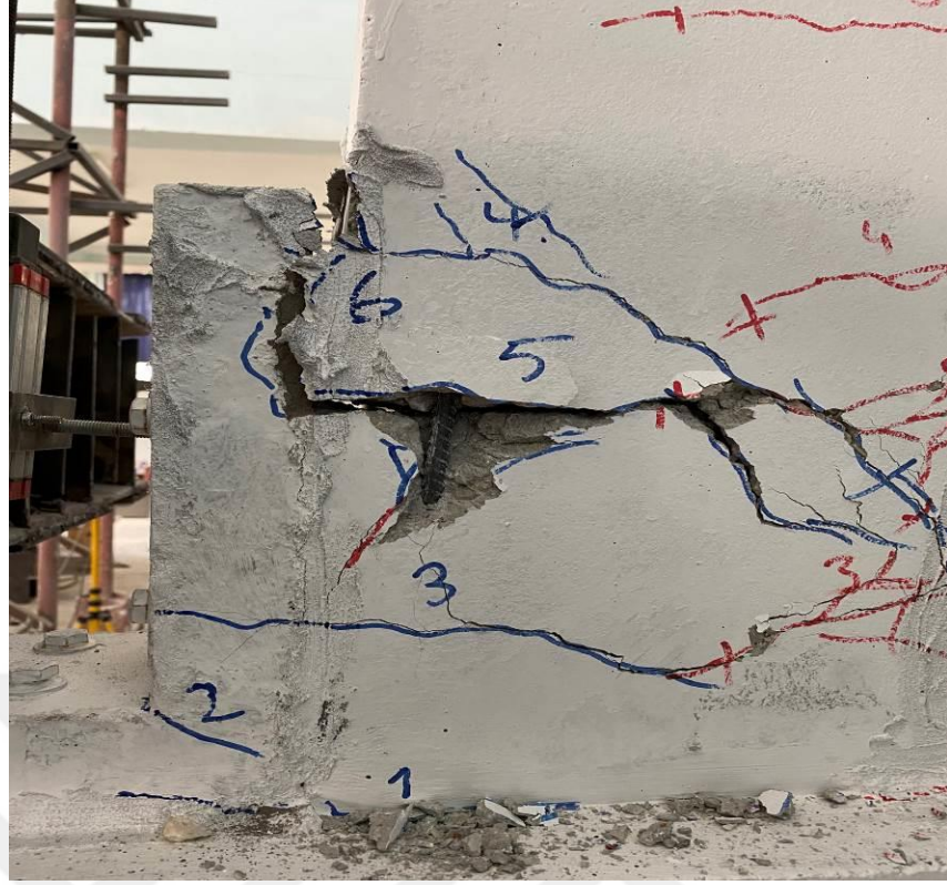
Şekil 4.66. RB- LDB2-SEW deney elemanında kabuk beton atma
