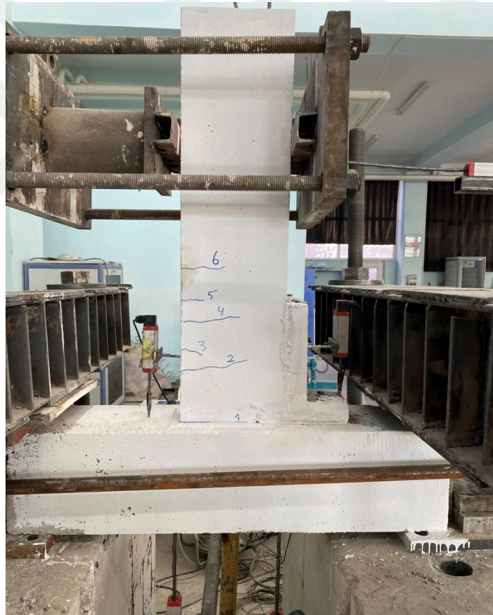
Şekil 4.12. RB-LDB1-SE deney elemanının ilk çatlaklar
