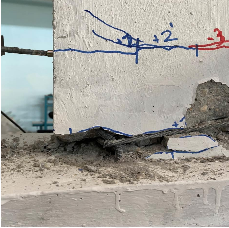
Şekil 4.5. Referans deney elemanında boyuna donatının burkulması
