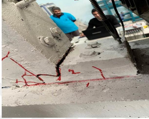
Şekil 4.13. RB-LDB1-SE deney elemanında kullanılan panelde oluşan ayrılma
