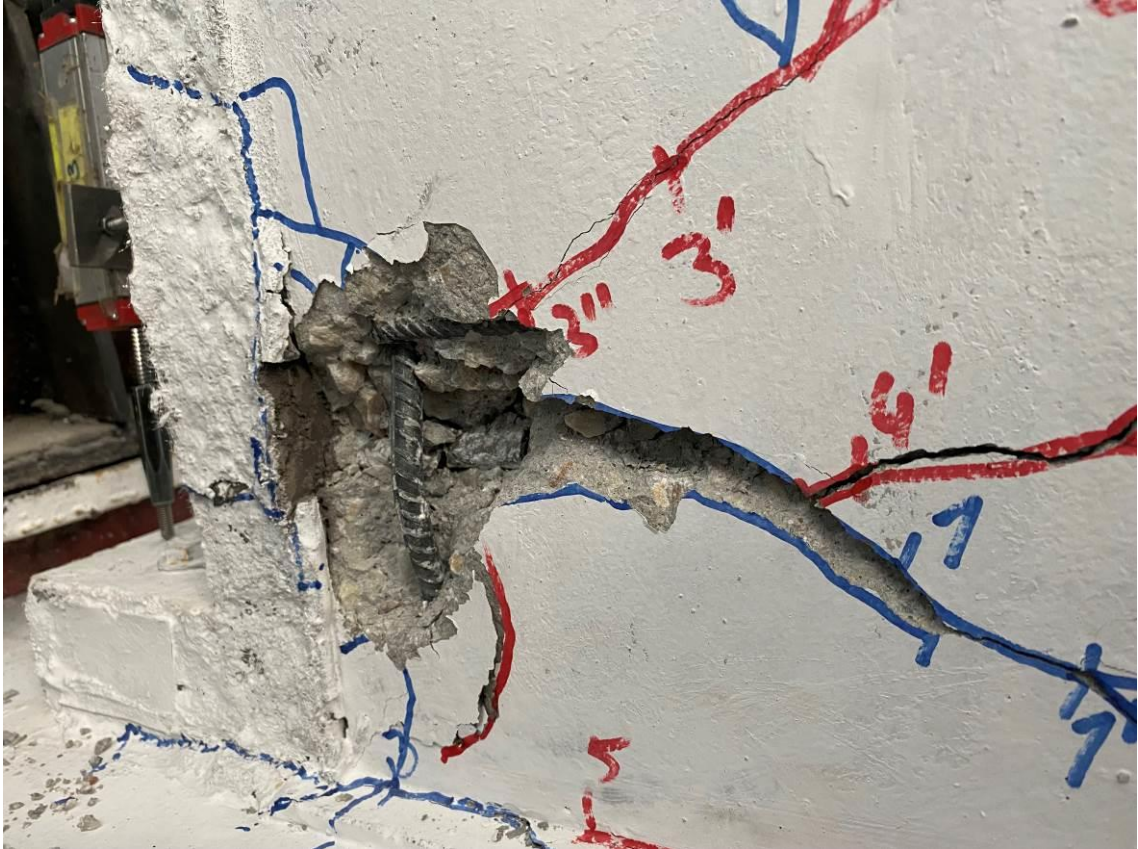
Şekil 4.87. RB- LDB2-LEW elemanında görülen donatı burkulması ve panel-kiriş birleşim yerinde meydana gelen hasar
