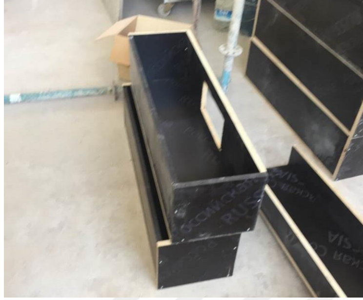
Şekil 3.6. Deney elemanları için hazırlanan kalıplar
