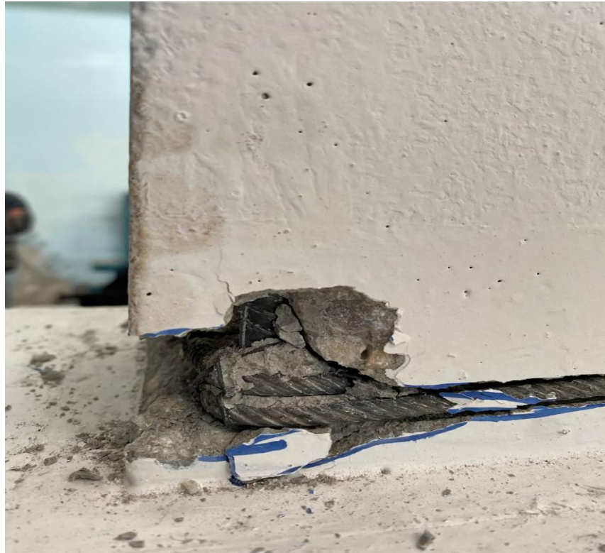
Şekil 4.34. RB-LDB1-LE deney elemanında paspayı dökülüp etriye görüldü
