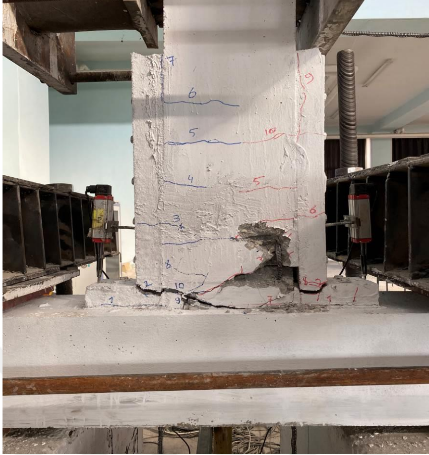
Şekil 4.47. RB- LDB1-LEW elemanın deney sonundaki çatlak dağılımı
