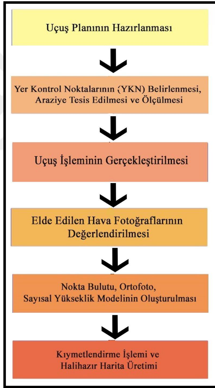
Şekil 3. 5. İHA fotogrametrisi hâlihazır harita üretimi aşamalarına ait iş akışı diyagramı
