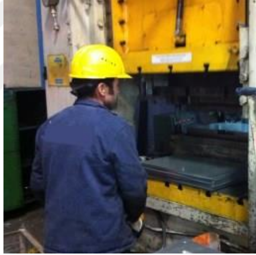
Şekil 5.1. Çalışma alanı korunmayan bir hidrolik pres
