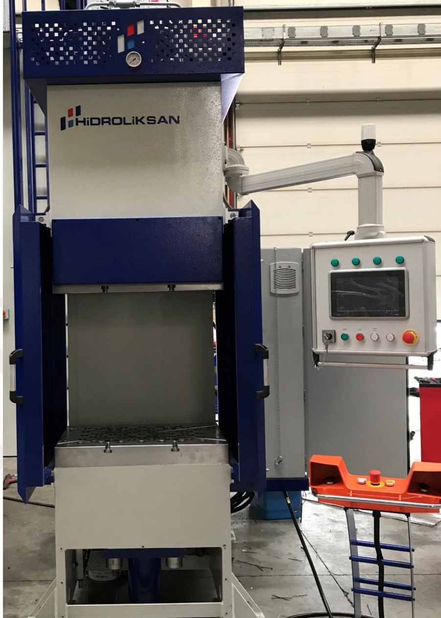
Şekil 3.2. C tipi hidrolik pres (Hidroliksan Halim Usta Pres San. Tic. Ltd. Şti., 2021)
