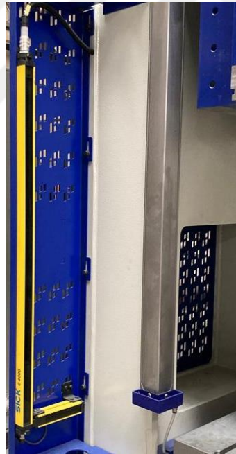
Şekil 6.18 Örnek yatay ve dikey bariyer konumlandırılması
