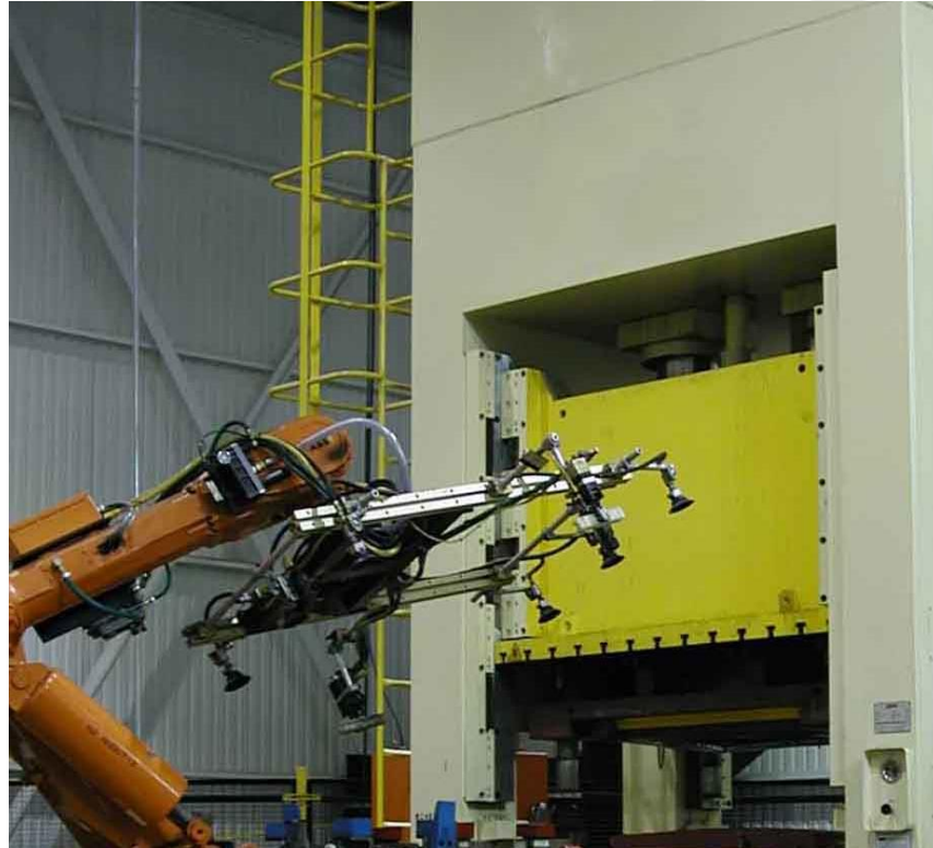
Şekil 5.3. Robot ile beslenen bir hidrolik pres
