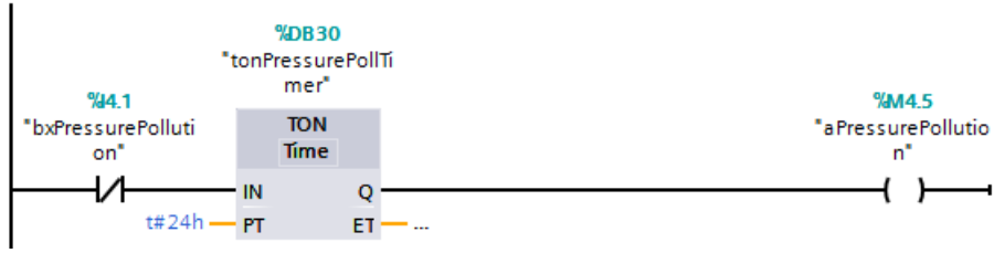
Şekil 6.53 Filtre kirlenmesi sonucu oluşan alarmların programlanması
