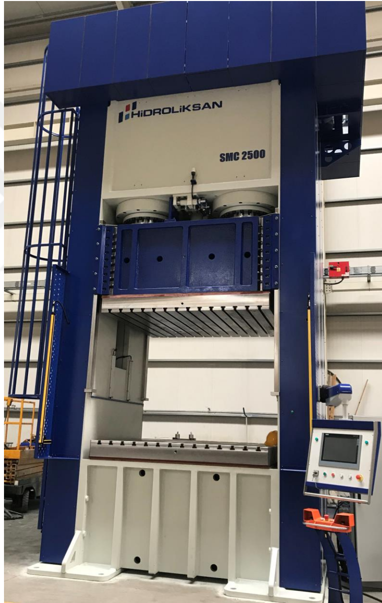
Şekil 3.1. H tipi hidrolik pres (Hidroliksan Halim Usta Pres San. Tic. Ltd. Şti., 2021)
