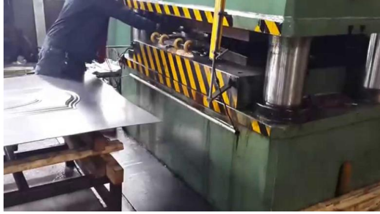
Şekil 5.2. Açık alanları kapatılmayan bir pres
