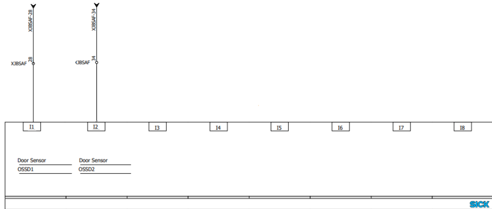
Şekil 6.26 Sick PLC ile kapı şalteri bağlantısı
