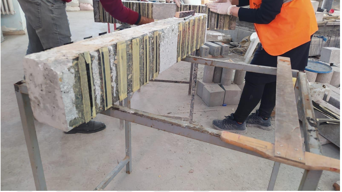
Şekil 3.14. Güçlendirme uygulaması (yan yüz sargılama)
