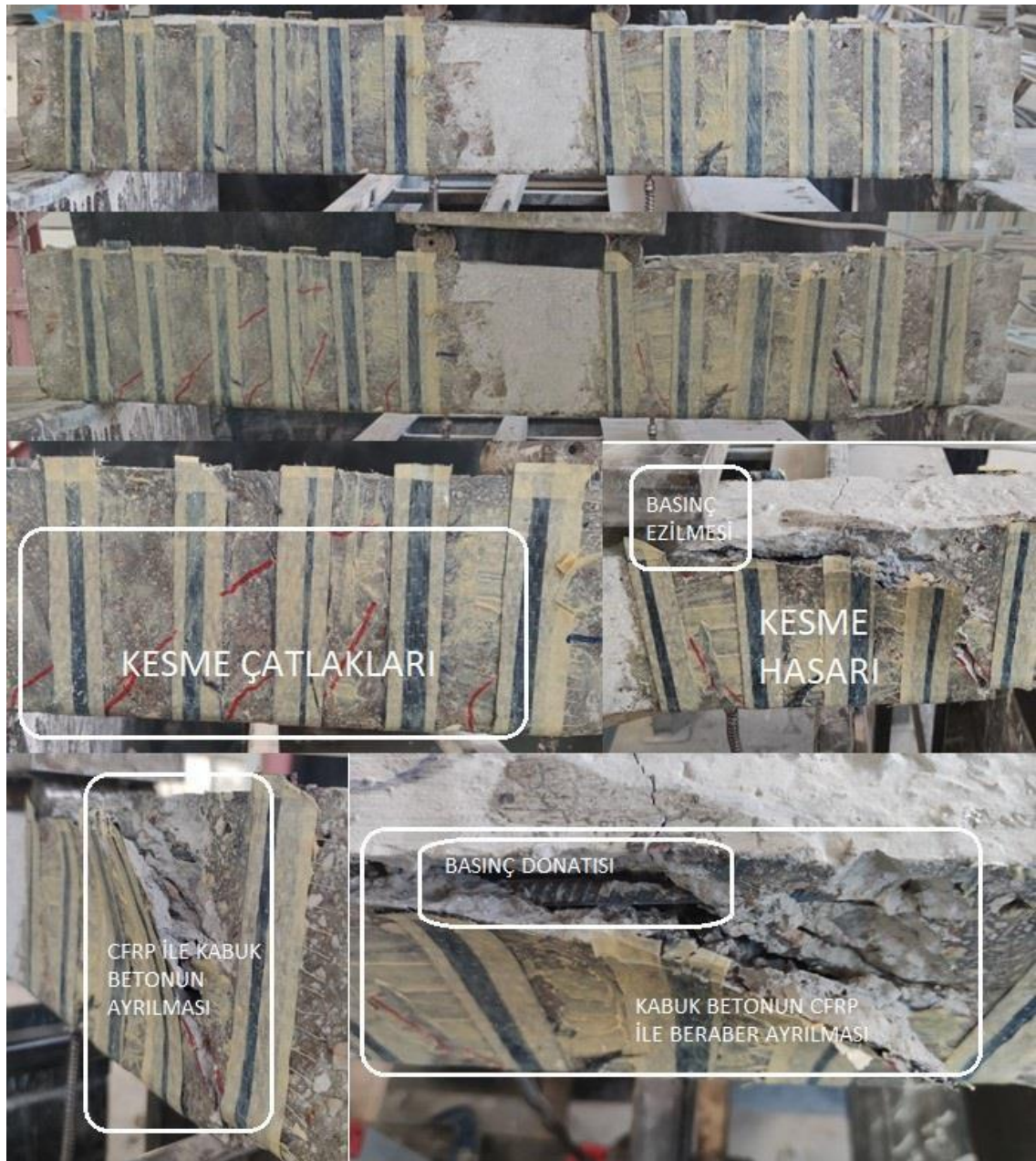
Şekil 4.31. BU 1 -1 numunesinin deney öncesi-sonrası ve detaylı görünümü
