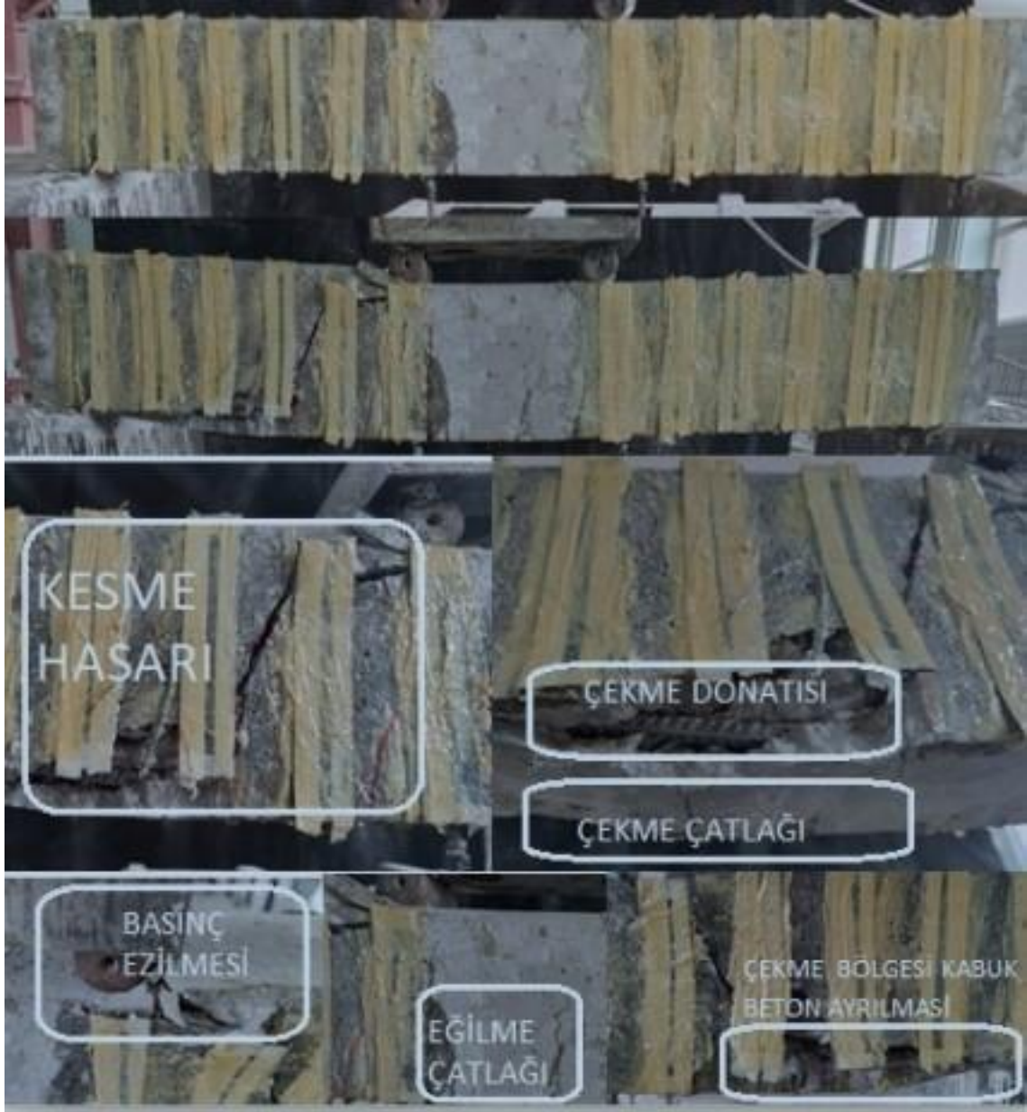
Şekil 4.67. BS 4 -2 numunesinin deney öncesi-sonrası ve detaylı görünümü
