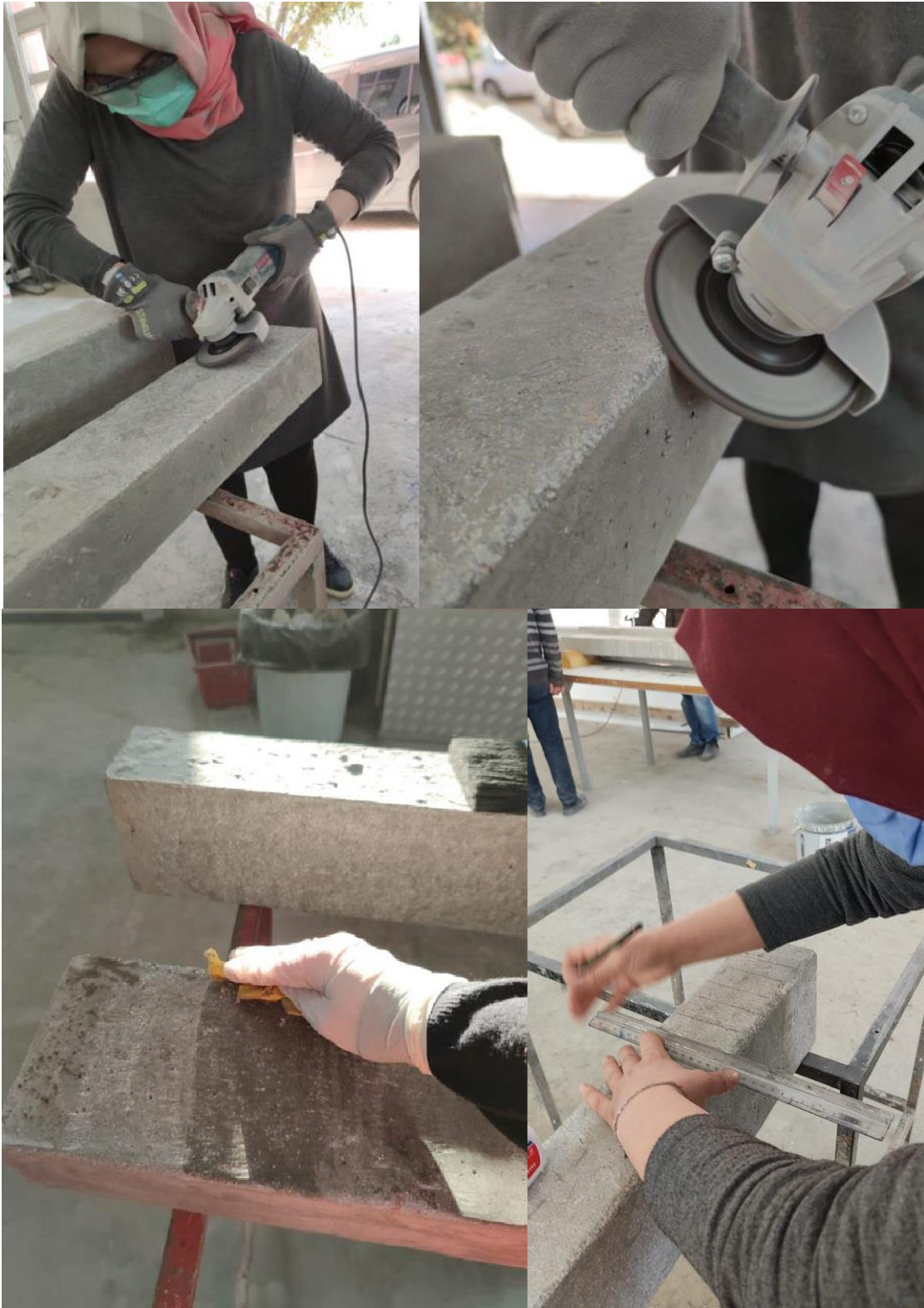
Şekil 3.12. Betonarme kirişlerin yüzey taşlama, pahlama, temizleme ve şerit genişliği ve aralıklarının işaretlenmesi
