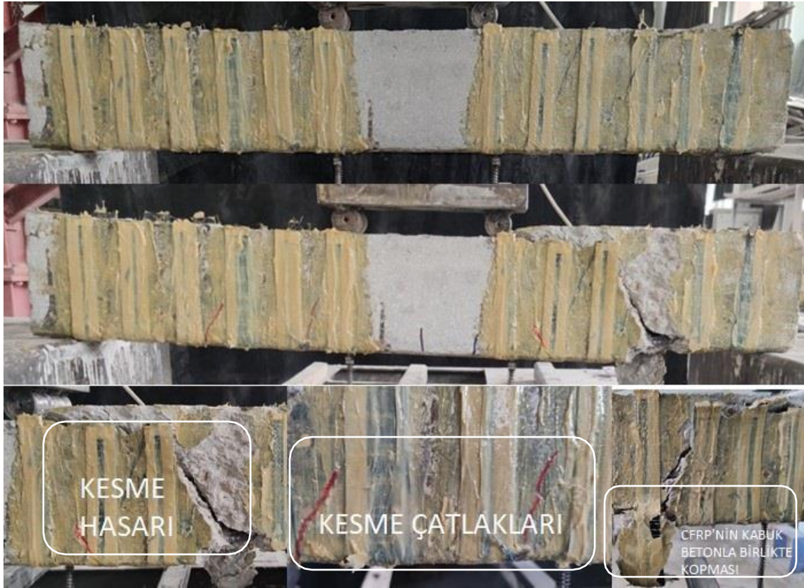
Şekil 4.43. BU 2 -2 numunesinin deney öncesi-sonrası ve detaylı görünümü
