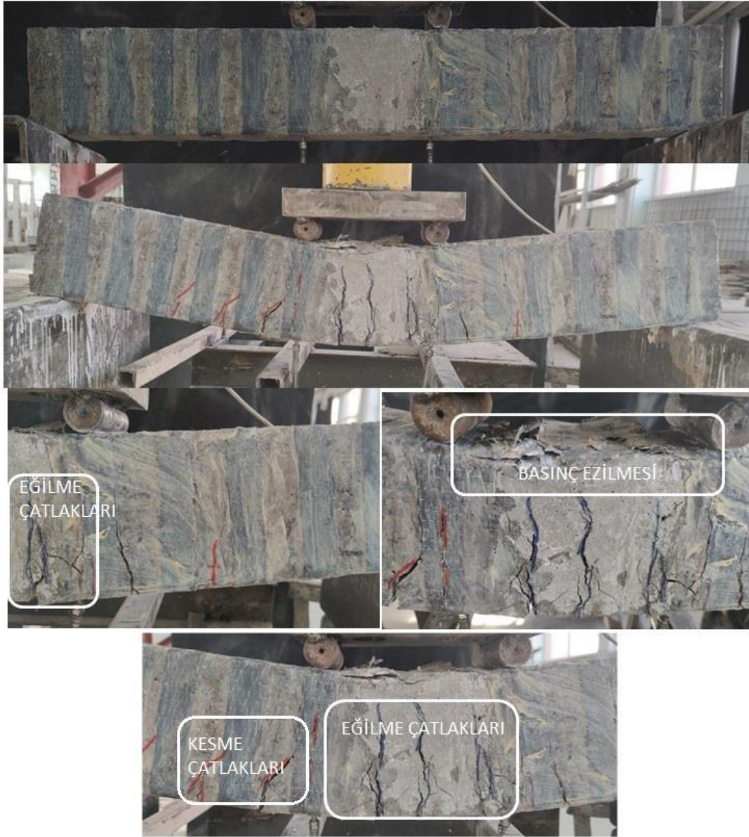
Şekil 4.19. BF 5 -1 numunesinin deney öncesi-sonrası ve detaylı görünümü
