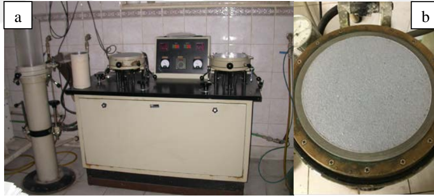
Şekil 3.7. (a) Kağıt örneğinin yapıldığı rapid cihazı (ET Enriko Toniolo), (b) Rapid cihazında numunenin preslenmesi (ET Enriko Toniolo)
