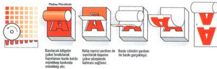
Şekil 2.5. Tifdruk (Tiefdruck) – Çukur baskı tekniği (Kocaman, 2014)
