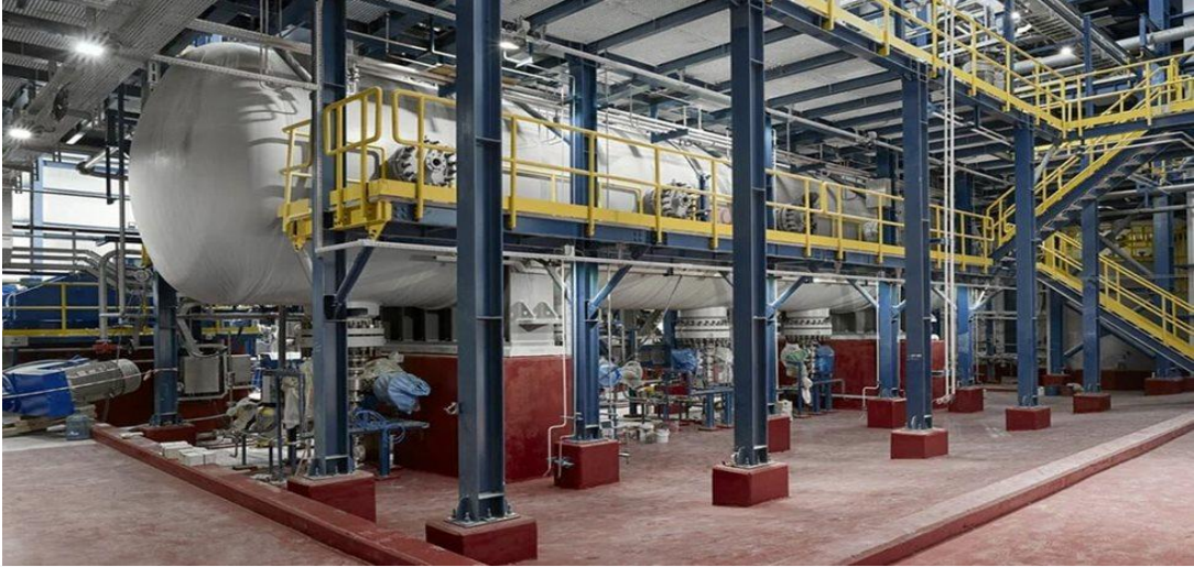
Şekil 2.6. Bakır liçinde kullanılan yatay otoklav.
