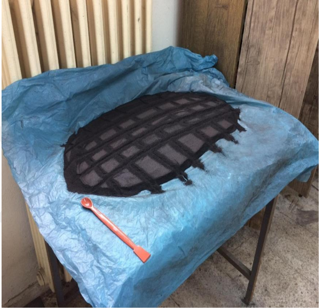
Şekil.3.1.Karelej yöntemi ile numunenin alınması
