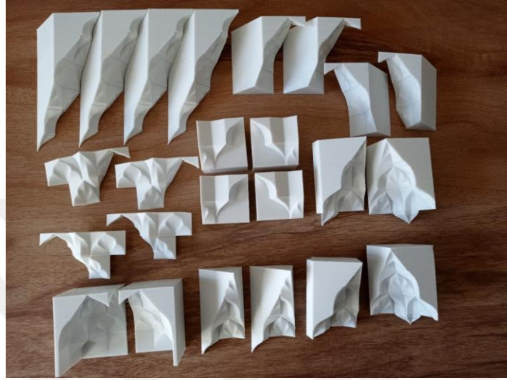
Şekil 5.32. 3B yazıcı ile üretilmiş süper karo blokları
