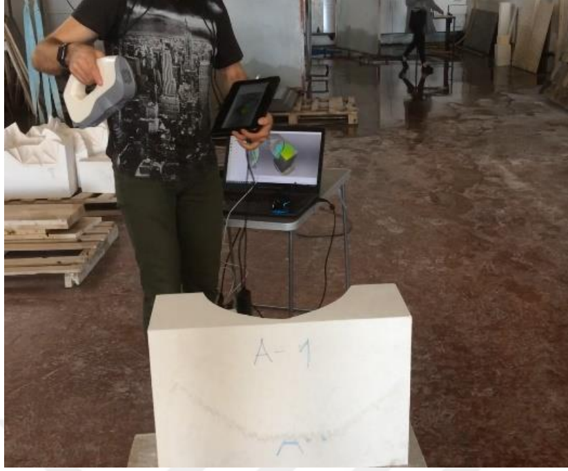
Şekil 3.36. 3B tarayıcı ile taranan model bloklar (Nevşehir Taşanlar Mermer Arşivi)
