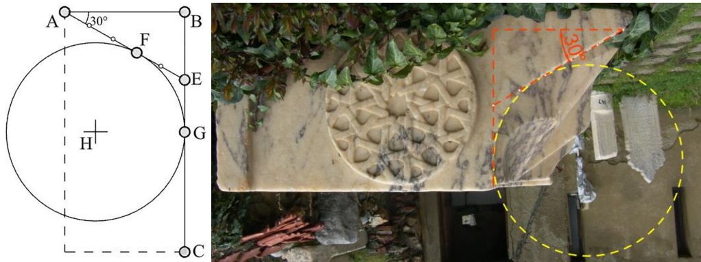
Şekil 5.20. El-Kaşi kavisli çizgi metodu (Dinçer ve Yazar, 2021) ve kavisli çizginin Akşehir Taş Medrese mukarnaslı taş bloğuna aktarımı (Konya Rölöve Anıtlar Müdürlüğü Arşivi,2014)
