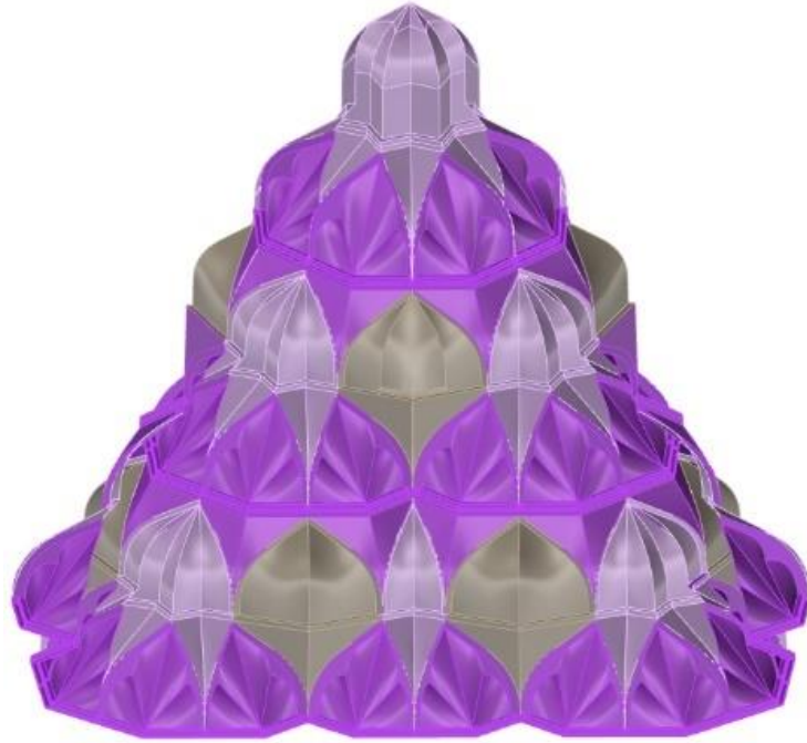
Şekil 5.13. Akşehir Taş Medrese mukarnası kare-baklava birim yüzeyleri
