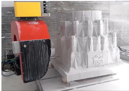
Şekil 3.40. OMAG Vlade 5AR makinesi ile mukarnas sütun başlığı yapım aşamaları (URL-44)
