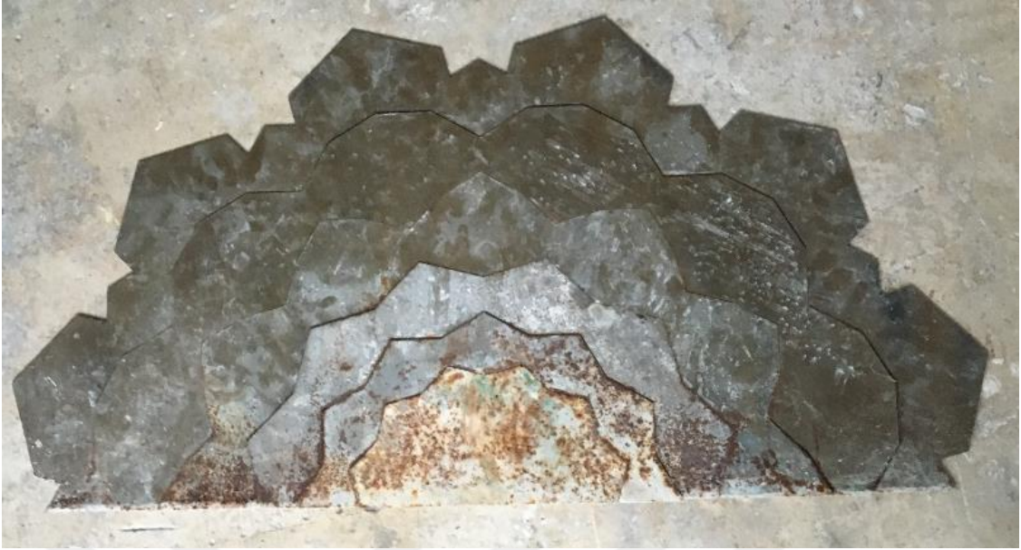
Şekil 3.26. Mermer bloklara işlenecek mukarnas kademelerinin belirlendiği çelik kalıplar (S.G. Dinçer Kişisel Arşivi, 2019)
