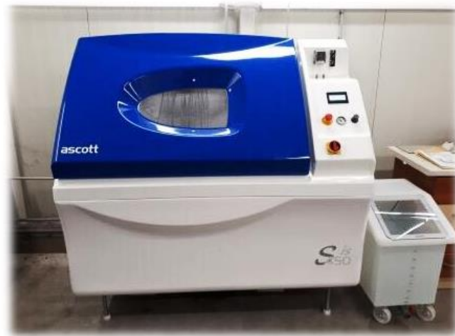
Şekil 3.18. Ascott S450iS tuz püskürtme test kabini
