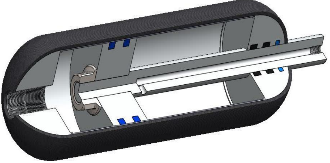
Şekil 5.2. Hidrolik silindir konsept tasarımı (Tip 1)
