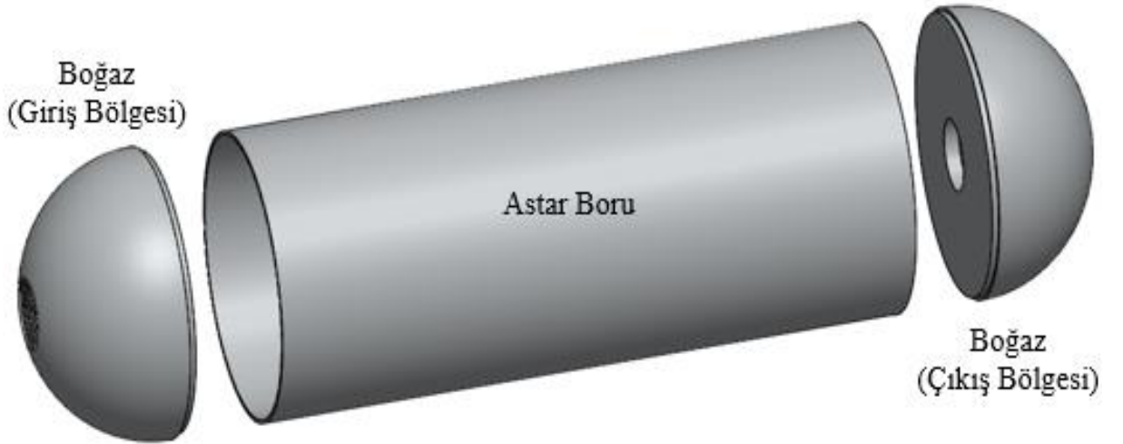
Şekil 5.1. Astar boru ve boğazların şematik gösterimi
