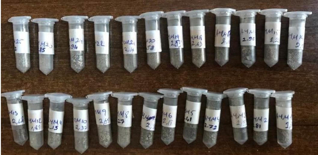
Şekil 3.3. Foraminifer ayıklama ve tür tayini için kullanılmak üzere plastik mikrosantrifüj tüplerinde muhafaza edilen sediment örnekleri
