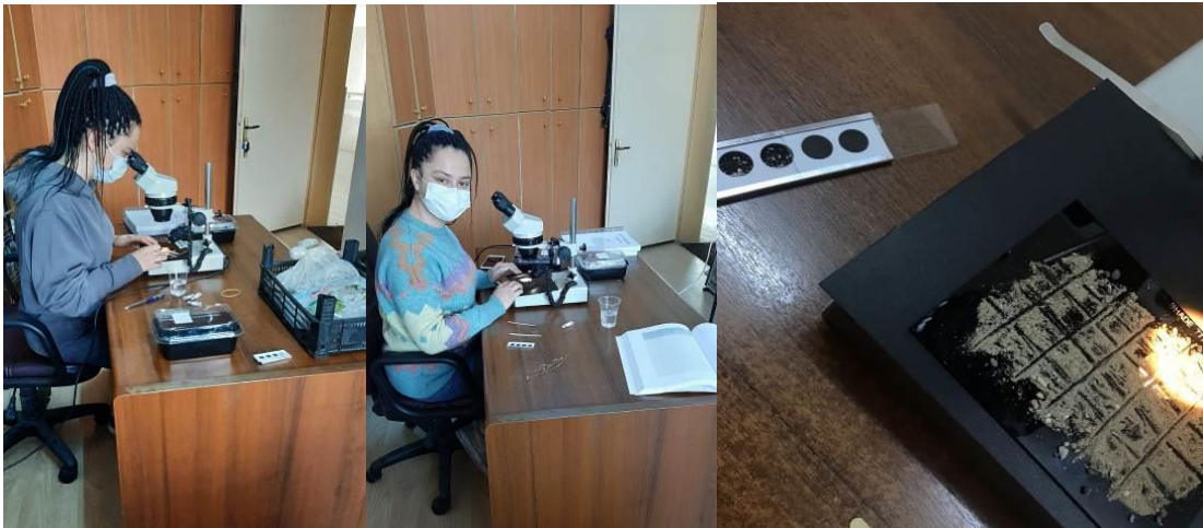
Şekil 3.4. Binoküler mikroskop altında sediment örneklerindeki bentik foraminiferlerin ayıklaması çalışmaları
