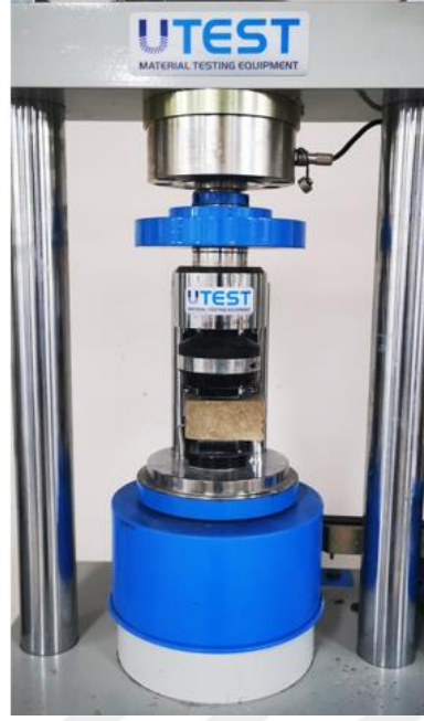
Şekil 3.33. Basınç Dayanımı testi
