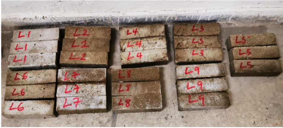
Şekil 3.17. Geopolimer harçların yanmaz fırın poşetlerin çıkarılması ve kür uygulanması
