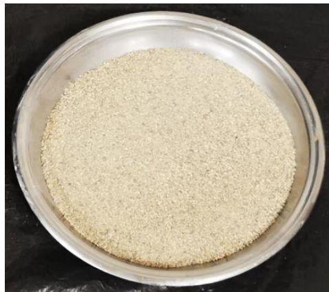
Şekil 3.10. İnce agreganın numunesi
