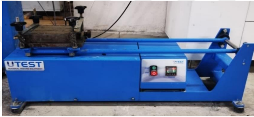
Şekil 3.22. Geopolimer harçların vibratör uygulanması
