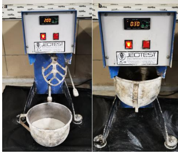
Şekil 3.21. a) Hammaddelerin mikserde yerleştirilmesi b) Karıştırma işlemi
