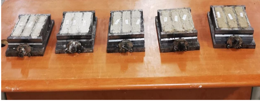
Şekil 3.24. Üretilmiş geopolimer harçları
