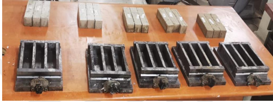
Şekil 3.25. Geopolimer harçların kalıplardan çıkarılması
