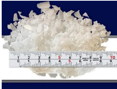
Şekil 3.12. Sodyum hidroksit peletleri
