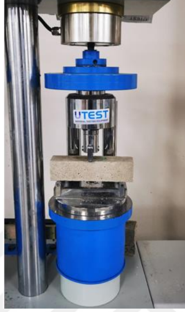
Şekil 3.32. Eğilme Dayanımı testi
