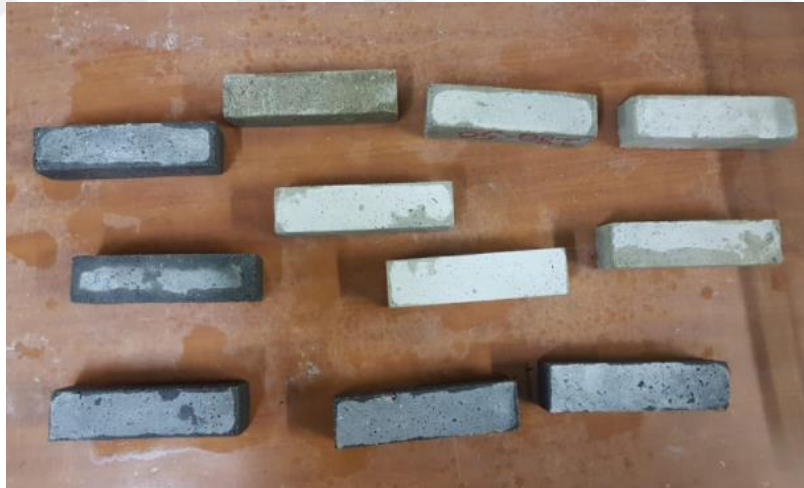
Şekil 3.30. Numunelerin parafin kaplanması
