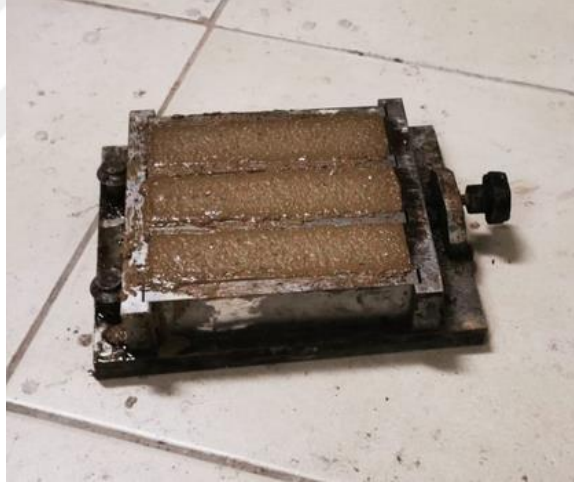
Şekil 3.15. Geopolimer harçların kalıplarda yerleştirilmesi
