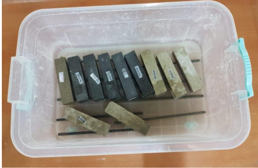
Şekil 3.31. Kapilarite katsayısı deneyi
