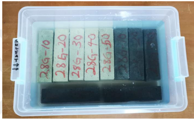
Şekil 3.37. Sülfat etkisi deneyi
