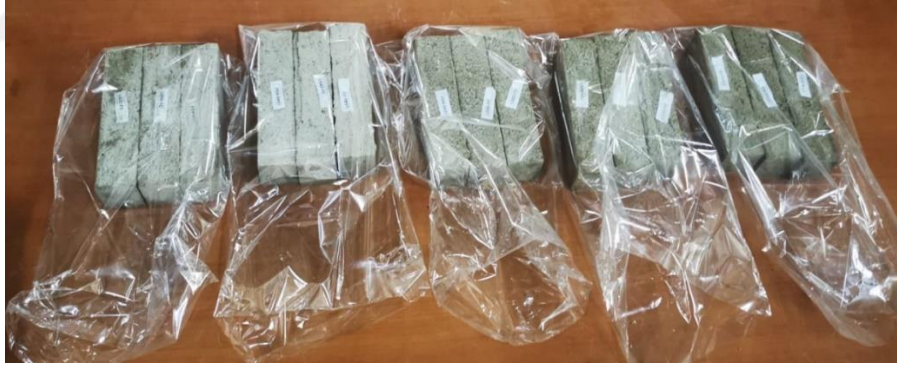
Şekil 3.26. Geopolimer harçların yanmaz fırın torbalarının konulması
