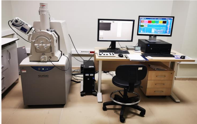
Şekil 3.40. Çalışmada kullanılan SEM-EDS cihazı
