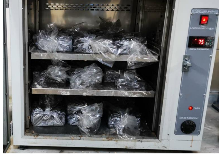
Şekil 3.27. Geopolimer harçların kür için fırında yerleştirilmesi
