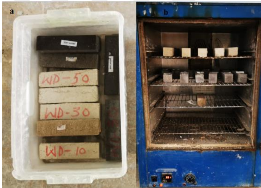
Şekil 3.36. Islanma kuruma deneyi a) Islanma için numunelerin suyu yerleştirilmesi b) Kuruma için numunelerin fırını yerleştirilmesi
