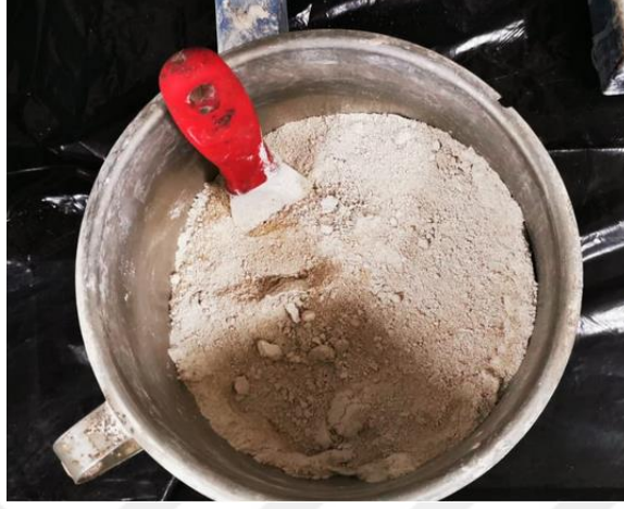
Şekil 3.14. Geopolimer harçların karıştırılması
