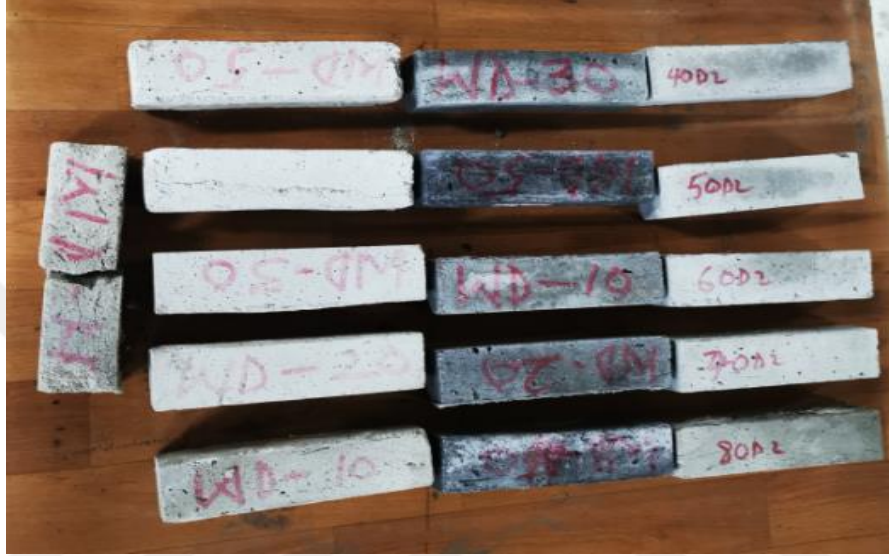
Şekil 4.21. Islanma-kuruma testinden sonra geopolimer harçları
