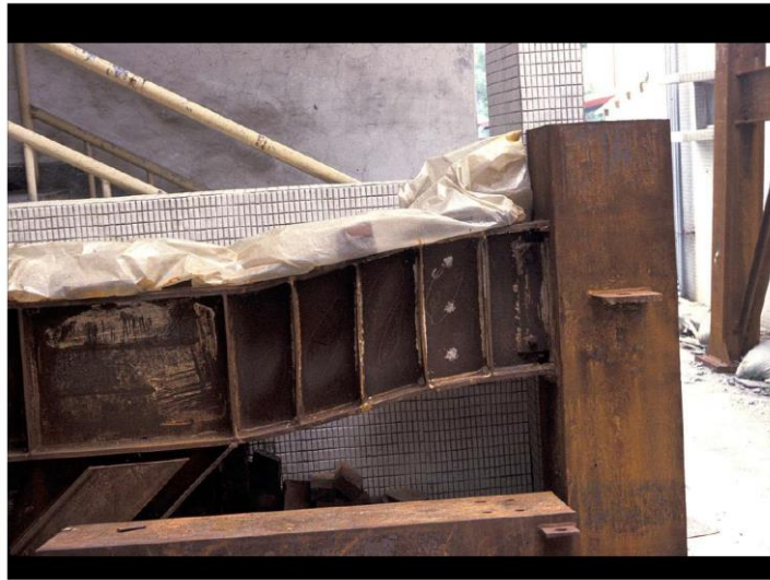
Şekil 3.14. Bağ kirişinin yatay yük etkisi altındaki deformasyonu ( https://encrypted-tbn0.gstatic.com/images?q=tbn:ANd9GcSIxb1618XgDak70Lv-Sc8FzHHu-G6ucSjBHA&usqp=CAU )
