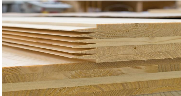
Şekil 4.5 Parmaklı birleşim için hazırlanmış kesit (URL- 2)
