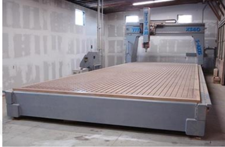
Şekil 4.10 Panellere CNC yönlendirici ile boşlukların açılması (URL- 6)
