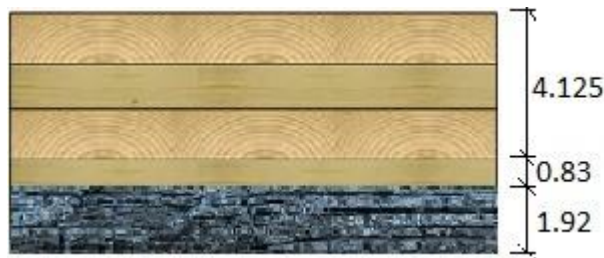
Şekil 7.2. Bir kısmı kömürleşmiş çapraz lamine ahşap panel
