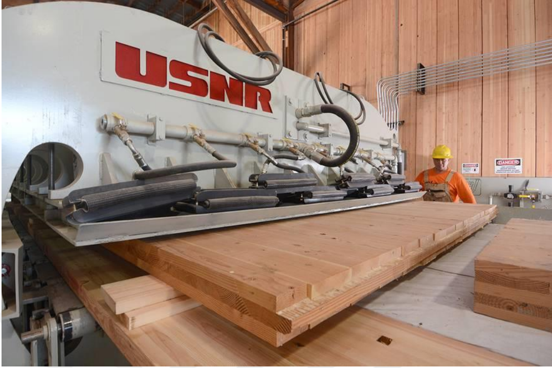
Şekil 4.8 Pres makinesi ile katmanların sıkıştırılması (URL- 4)
