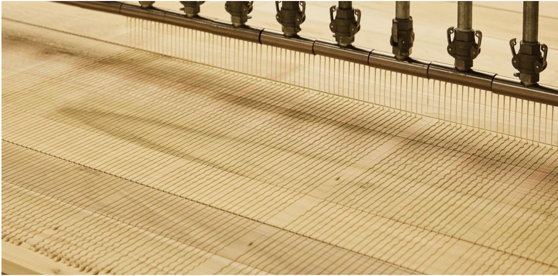
Şekil 4.7 Katmanlar arası yapıştırıcı uygulaması (URL- 3)
