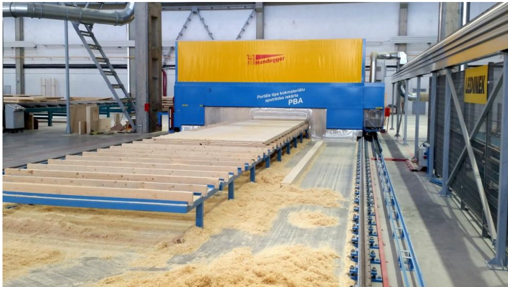
Şekil 4.9 Birleştirilmiş panel yüzeylerinin makine aracılığıyla planyalanması ve zımparalanması (URL- 5)
