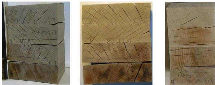
Şekil 4.11 Delaminasyon testine tabi tutulmuş numuneler (Aicher ve Reinhardt, 2007)
