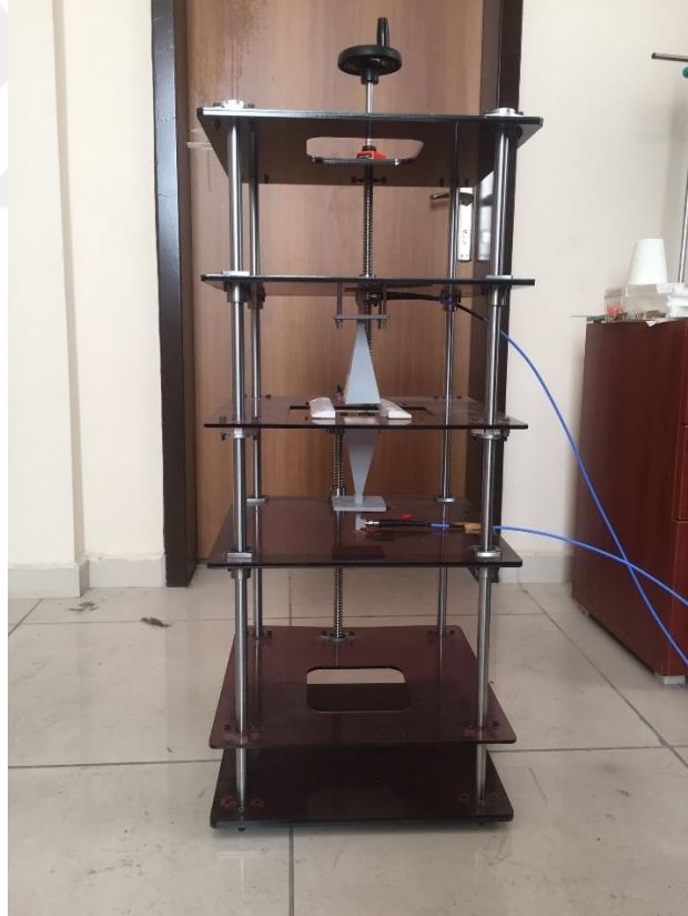
Şekil 3.18. Gerçek zamanlı ölçümler için boş-uzay ölçüm düzeneği
