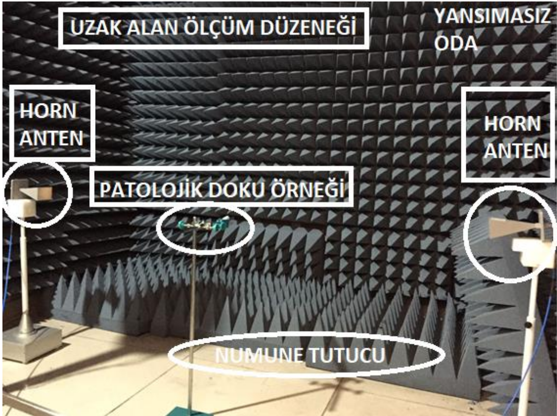
Şekil 4.12. Horn antenler kullanılarak hazırlanan uzak alan ölçüm düzeneği
