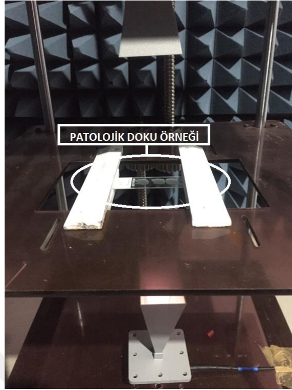
Şekil 4.11. Horn antenler kullanılarak hazırlanan ölçüm düzeneğinin doku örneği olan hali
