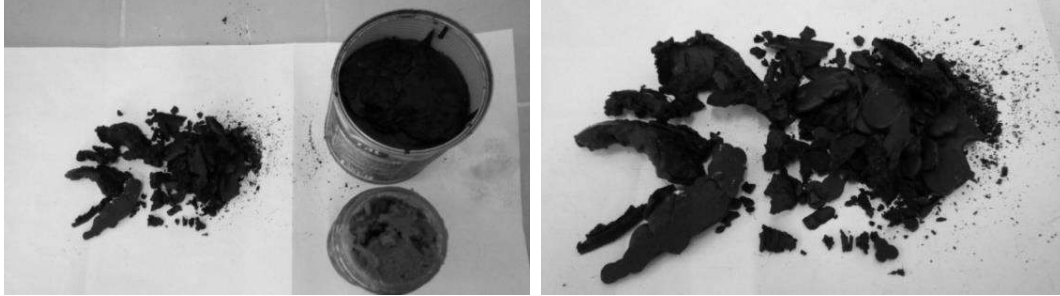
Şekil 3. PP-YYPE-PET plastik karışımının pirolizi sonucu elde edilen katı ve sıvı ürün
