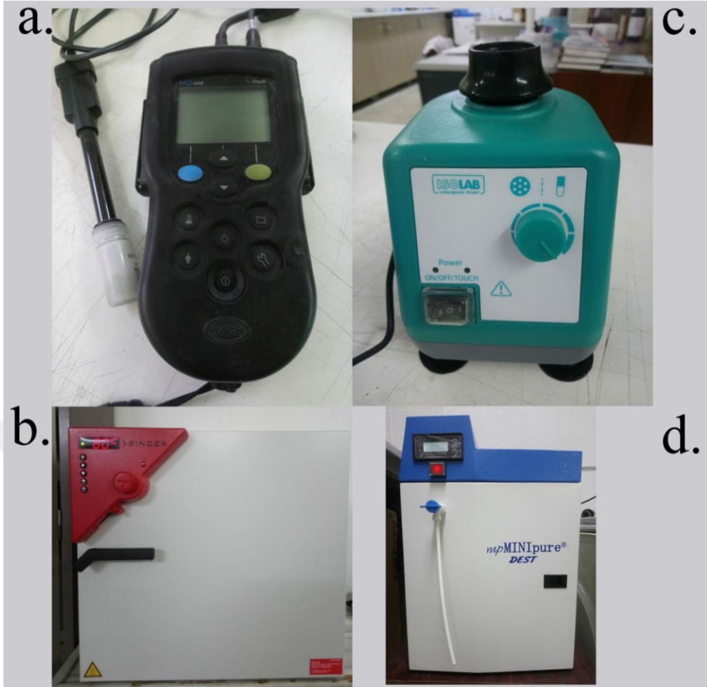
Şekil 3.2. a) pH metre, b) etüv, c) vorteks cihazı, d) saf su cihazı.
